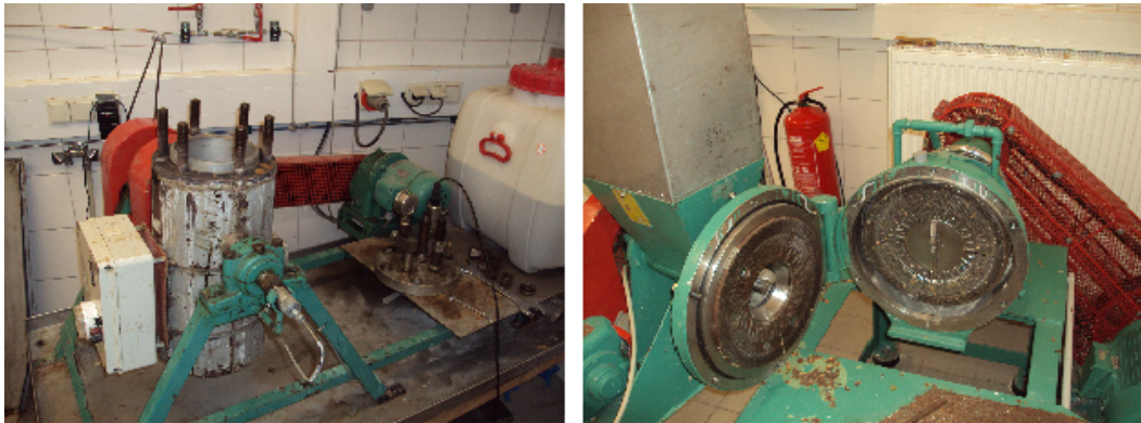
Abbildung 3.3 Probenvorbereitung zur Simulation der In-line-Mahlung in dem Laborrefiner. Temperierung von Zellstoff im Laborkocher (links) und Mahlung im atmosphärischen Laborrefiner (rechts).
