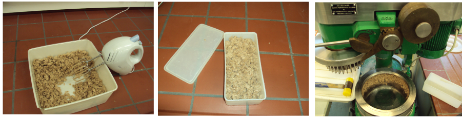
Abbildung 3.7 Probenvorbereitung zur Simulation alternativer Mahlstrategien in der PFI-Mühle. Zerkleinerung des Zellstoffes mit einem Mixer gefolgt von der Anpassung der Stoffdichte in einem speziellen Behälter und der gleichmäßigen Verteilung des Stoffes in der Mahlbüchse.
