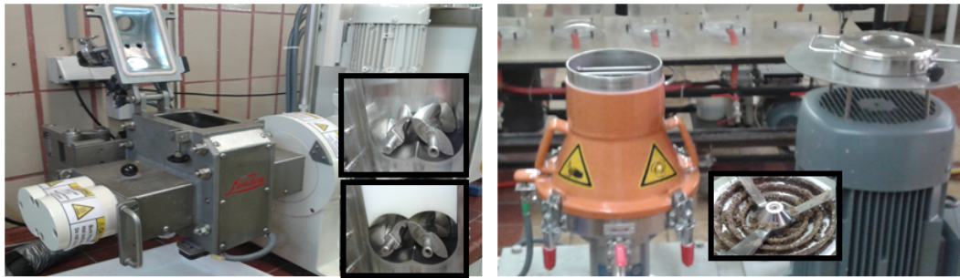
Abbildung 3.1 Knet- (links) und Scheibendisperger (rechts) an der Technischen Universität Darmstadt. Die eingeblendeten Bilder zeigen die Mahlzone. Jene im Knetdisperger ist mit und ohne Kunststoffeinsätze dargestellt.
