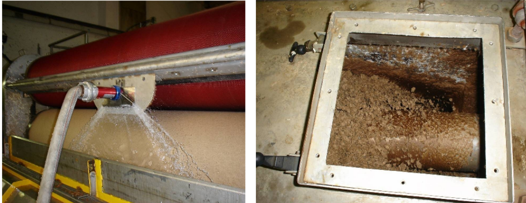
Abbildung 3.6 Sprühhvorrichtung zur Reduktion des Trockengehaltes im Hochkonsistenz-Refiner der PM8 (links) und Zellstoff-Flocken nach der Zerkleinerung der Bahn im Zerreiser (rechts).
