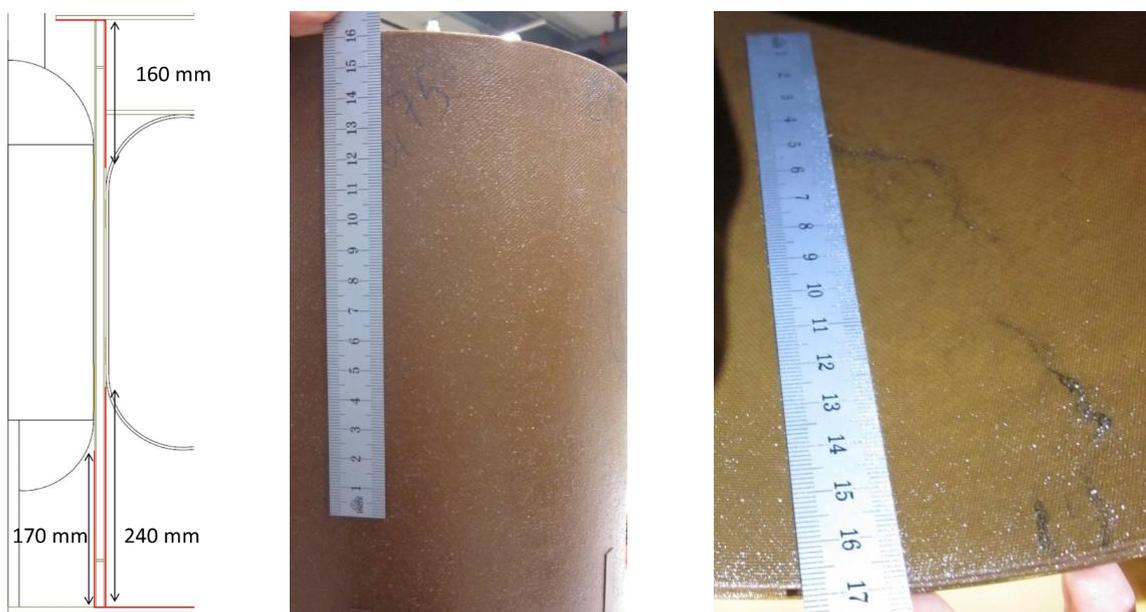
Abbildung 8-1 – Skizze der Überslagsspuren (links) – Vermessung der Spuren am Boardzylinder (mittig, rechts)
