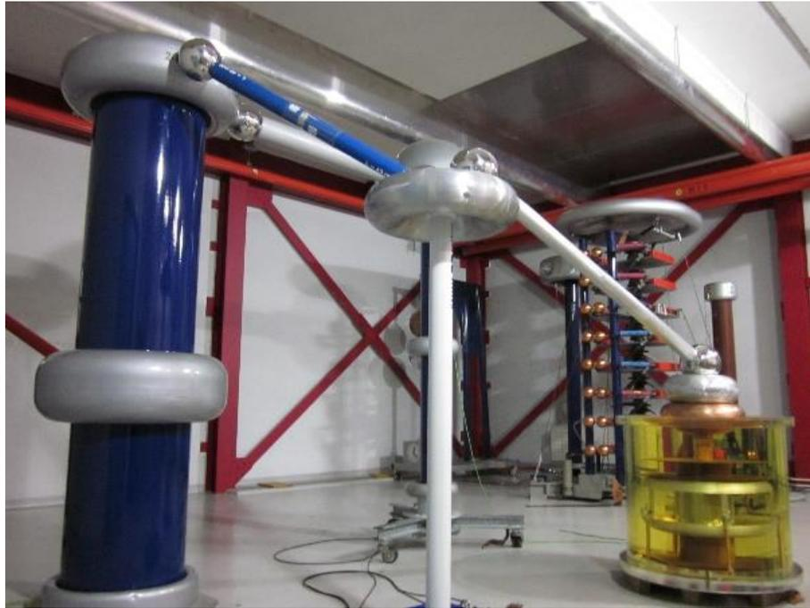
Abbildung 6-4 – Eingebauter Prüfling mit Verbindung zur Prüfkaskade
