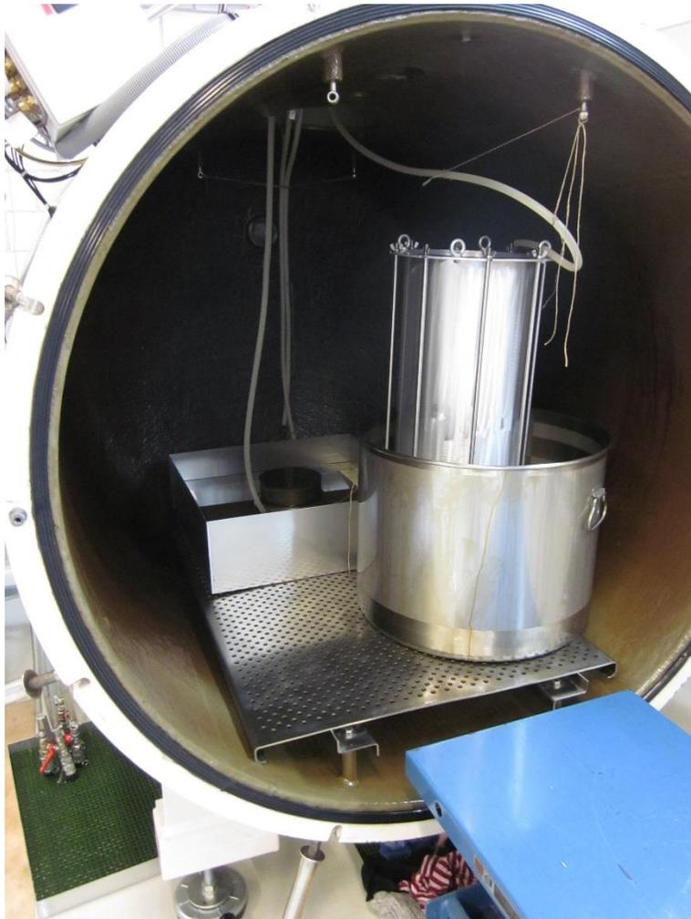
Abbildung 6-1 – Vakuumofen bestückt mit den Prüflingen
