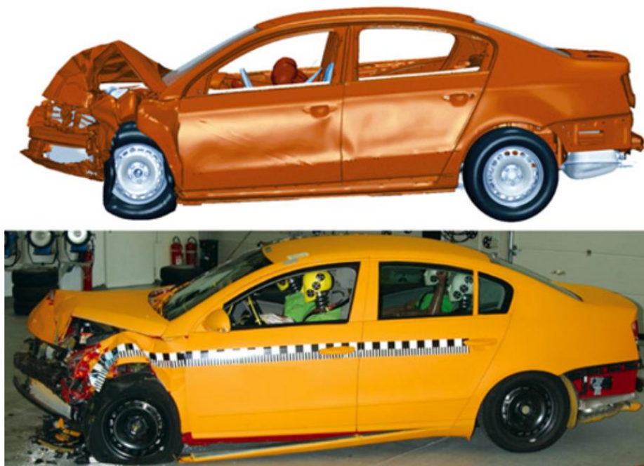
Abbildung 3: Finite Elemente Simulation eines Crashtests und realer Crashtest eines PKW [34]
