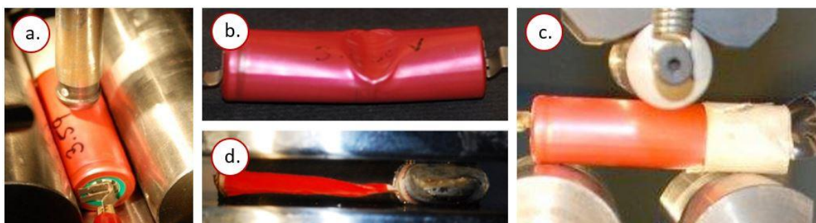
Abbildung 13: Versuchsanordnungen von Sahraei mit a.) Penetration mit zylindrischem Impaktor, b.) Penetration mit kugelförmigem Impaktor, c.) 3-Punkt-Biegung und d.) Crush in radialer Richtung [16]
