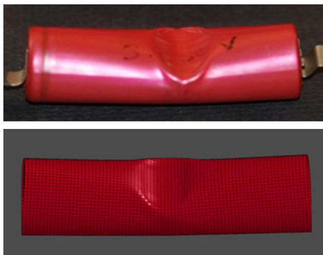
Abbildung 19: Vergleich Zelltest und Simulation von Sahraei [16]
