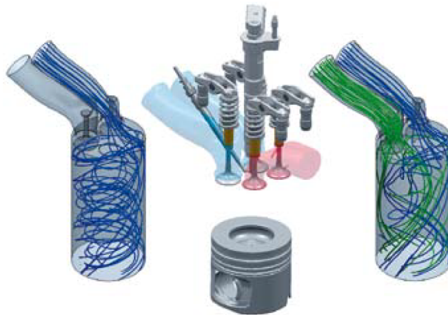
Abbildung 3.20: Geschlossene (links) und geöffnete (rechts) Drallklappe [22]
