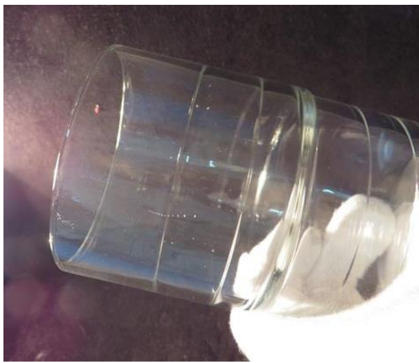
Abbildung 89: Kalk-Natron-Glas nach 30 Spülzyklen
