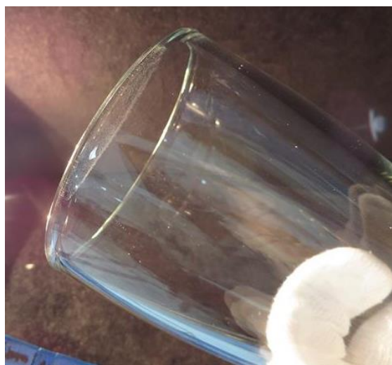
Abbildung 108: Kalk-Natron-Glas nach 30 Spülzyklen
