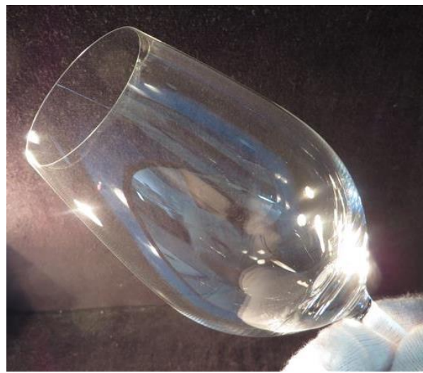
Abbildung 90: Bleikristallglas nach 30 Spülzyklen
