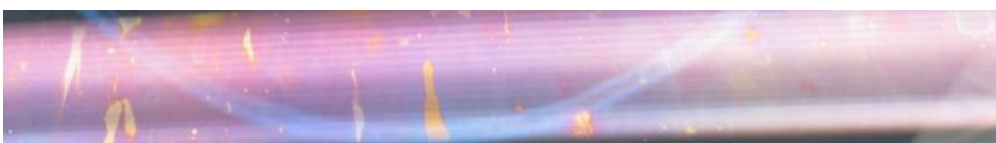
Abbildung 93: irisierender Effekt auf Glasplatte
