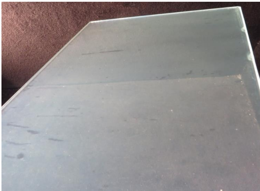
Abbildung 92: Oberfläche der Glasplatte nach 30 Waschzyklen
