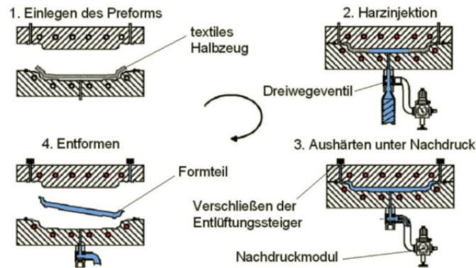
Abbildung 25: Prozessschritte des RTM-Verfahrens 202
