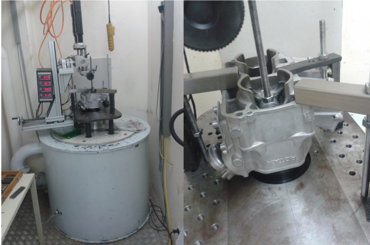
Abbildung 3-3: Fotos von der Vermessung der Überströmkanäle
