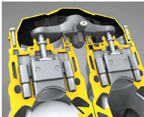
Abbildung 2-5: Schematische Darstellung eines Auslasschiebers [2]
