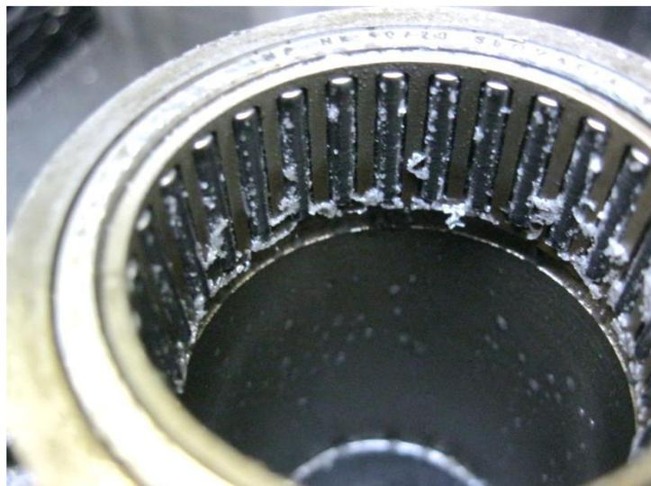
Abbildung 5.34 Verunreinigtes Wellenlager (Bild, Frigopol)
