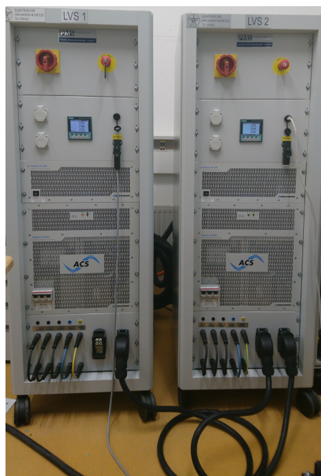
Abbildung 4.33: Messaufbau bei der Messung mit beiden Leistungsverstärkern
