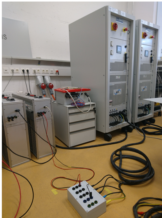
Abbildung 5.16: Messaufbau beim Entladevorgang
