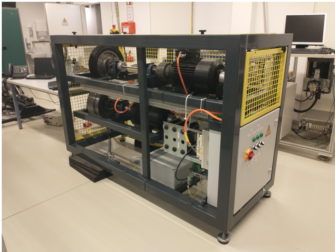
Abbildung 1: Seitenansicht des verwendeten Antriebsstrangprüfstands im Kellerlabor des Institutes für Regelung und Automatisierungstechnik der TU Graz.
