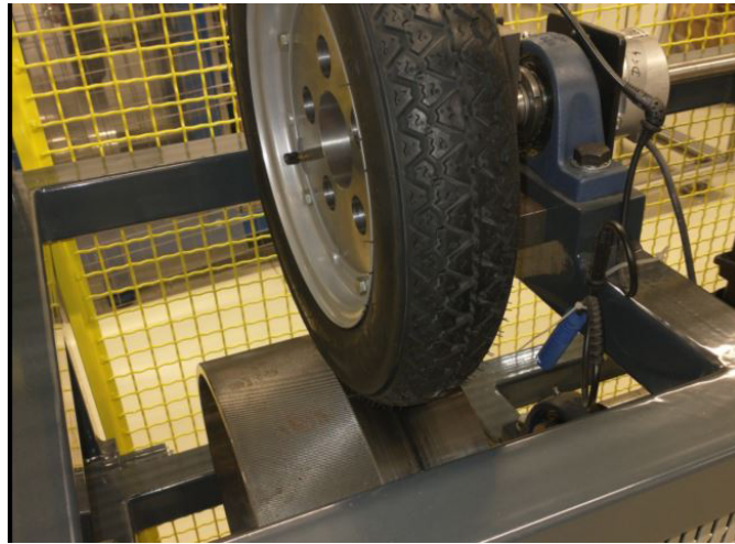
Abbildung 2: Detailansicht des Antriebsstrangprüfstands welche den Kontakt zwischen Walze und Reifen zeigt.
