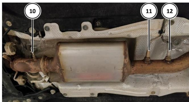
Abbildung 3.2: SCR-Katalysator im Fahrzeugunterboden
