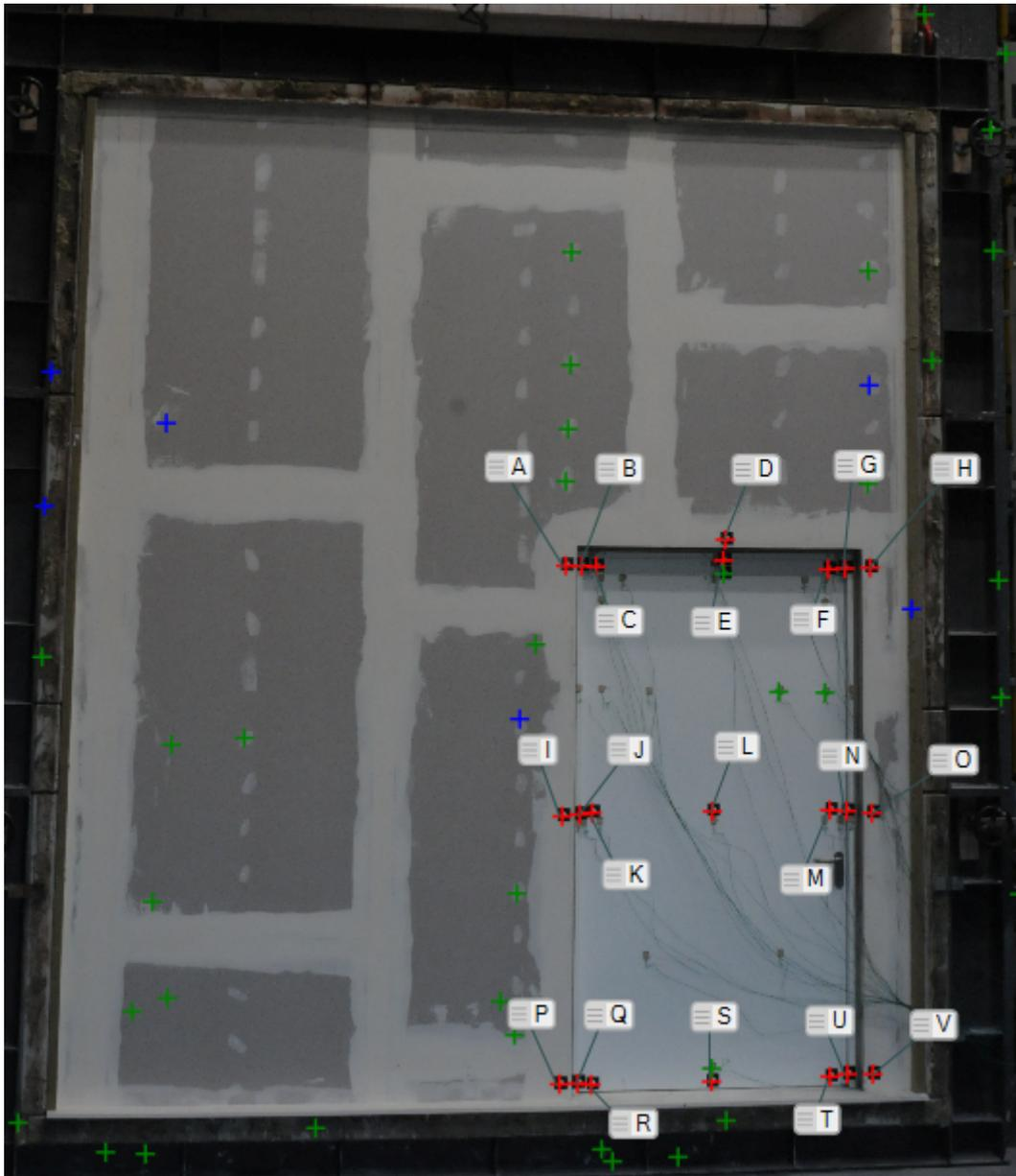
Abbildung 4.8: Messpunkte auf den Leichtbauwänden am Beispiel der Wand mit rechts eingebaute Tür; Die Benennung der Messpunkte kann für die anderen Konfigurationen abweichen.
