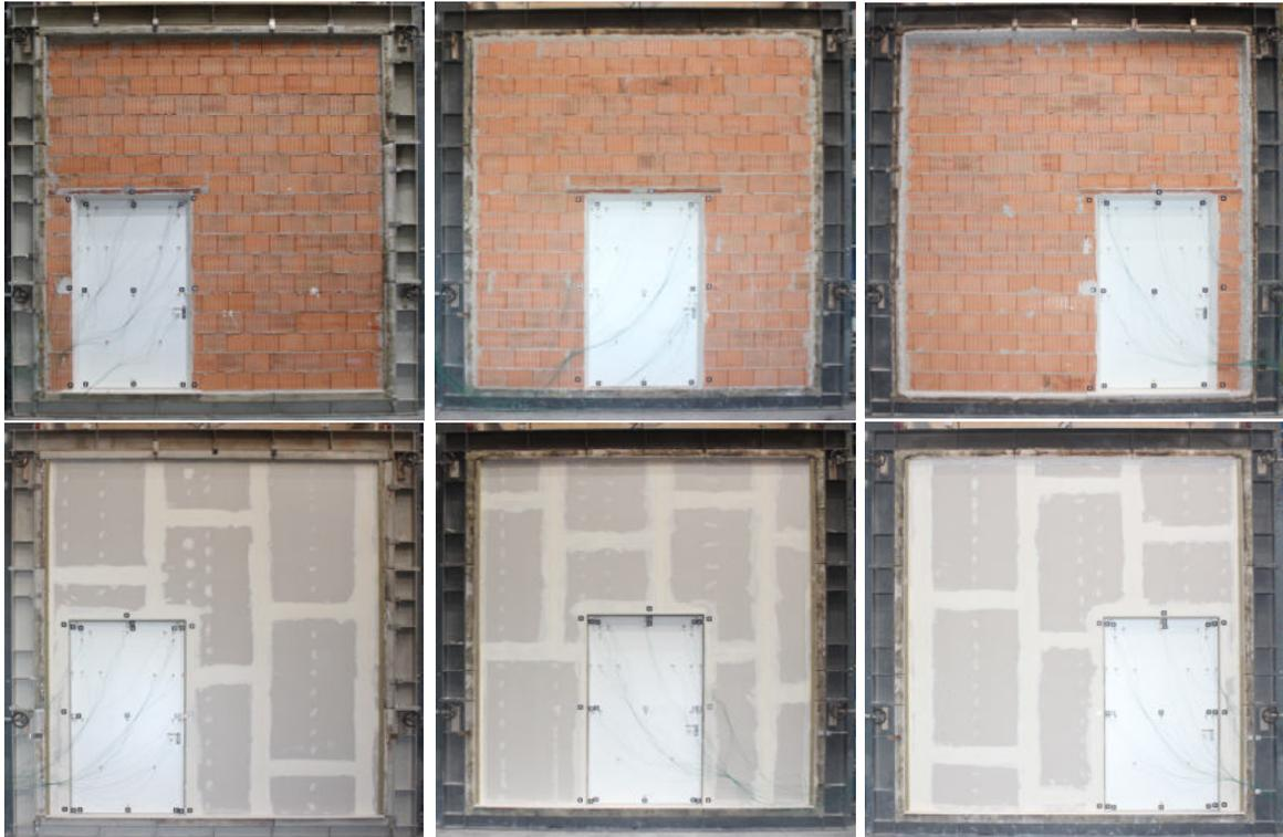
Abbildung 1.3: Ziegelwand- (oben) und Leichtbauwandkonfigurationen (unten), anhand derer das Modell in der vorliegenden Arbeit aufgebaut und validiert wurde.
