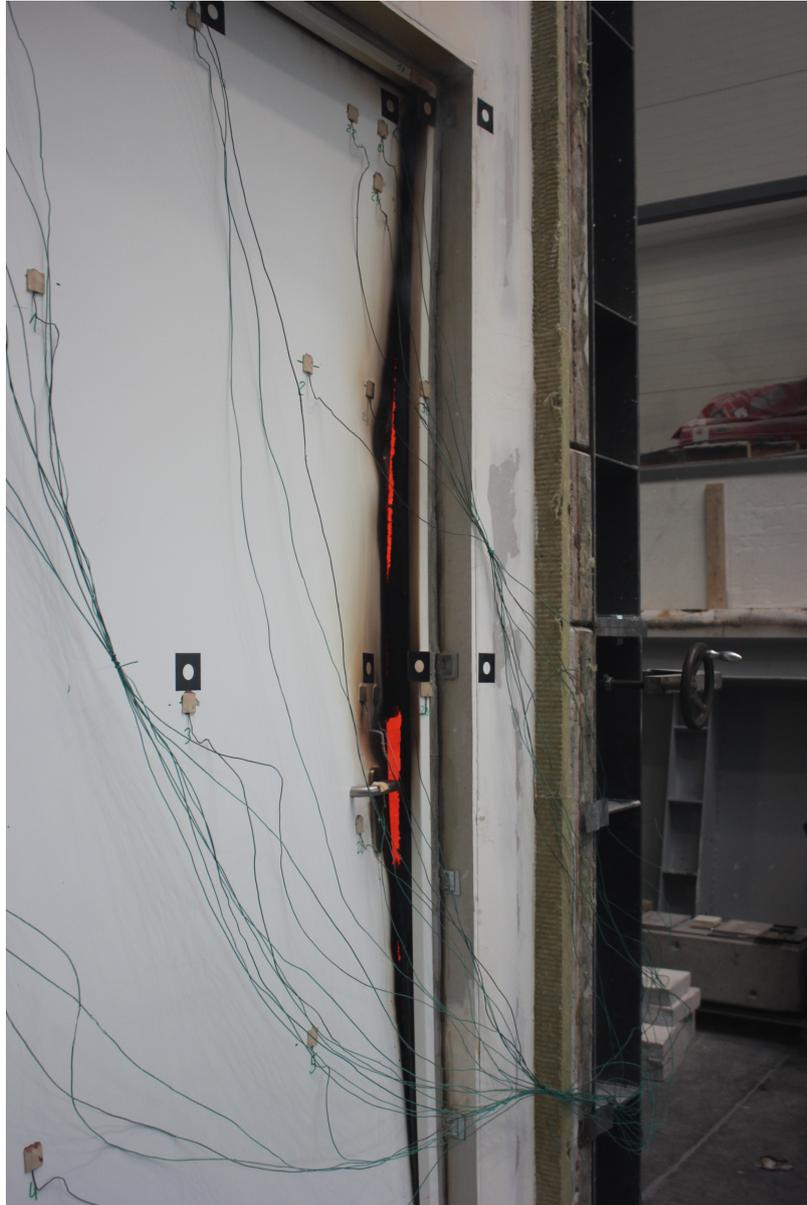
Abbildung 5.13: Ausreißen des Schlosses bei fortgeschrittener Versuchsdauer (ca. nach 30min)
