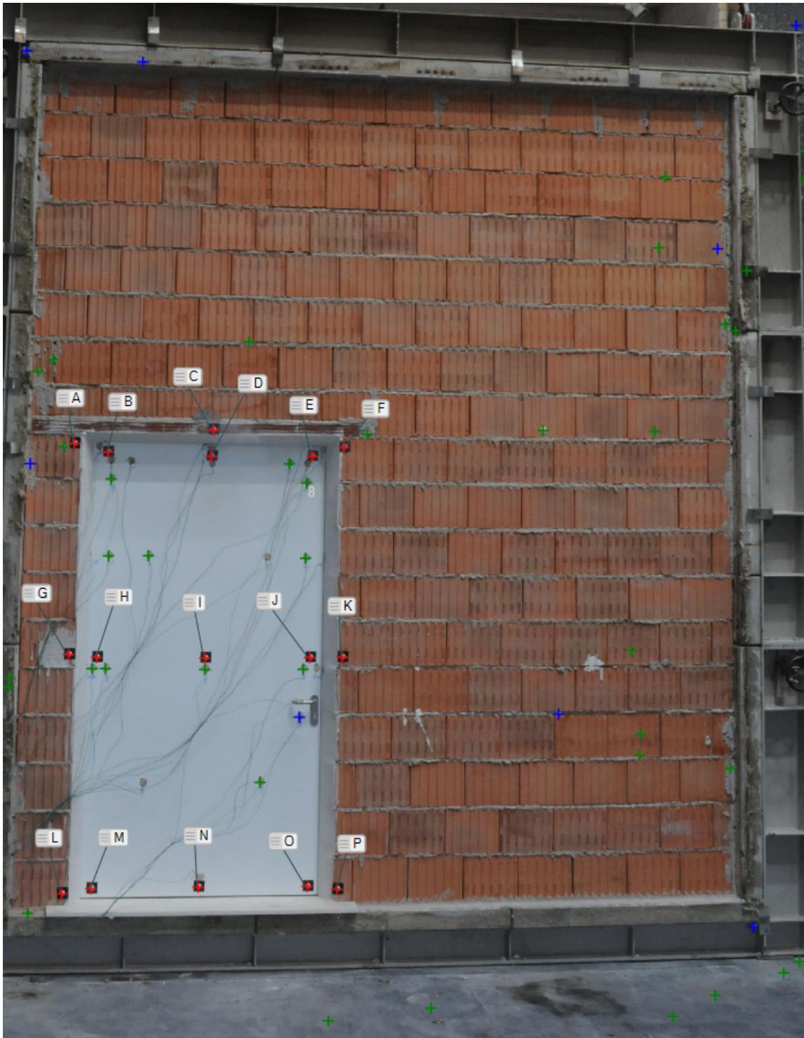
Abbildung 4.4: Messpunkte auf den Ziegelwänden am Beispiel der Wand mit links eingebauter Tür
