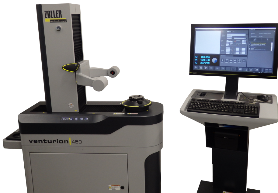
Abbildung 15: Werkzeugvoreinstellgerät Zoller »venturion 450« Quelle: Eigene Darstellung.
