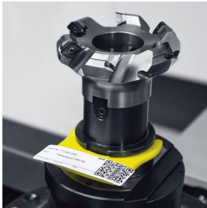
Abbildung 12: DMC-basiertes Etikettensystem Quelle: E. Zoller GmbH & Co. KG (2021b).
