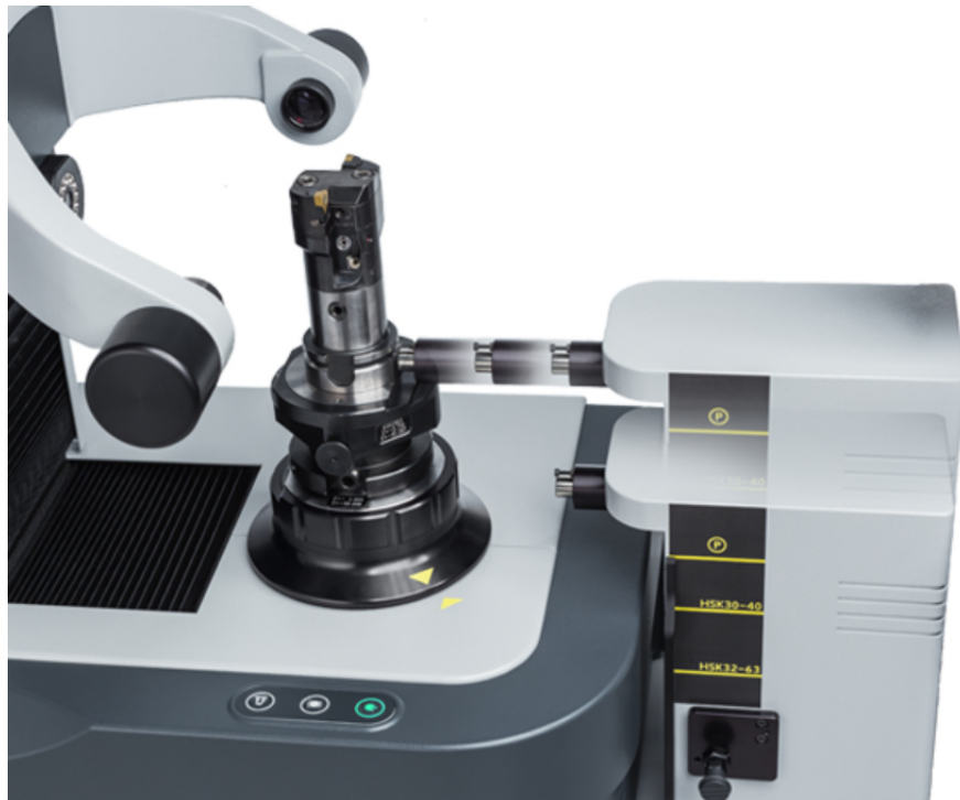
Abbildung 11: Beschreibungsprozess eines RFID-Chips am Voreinstellgerät
