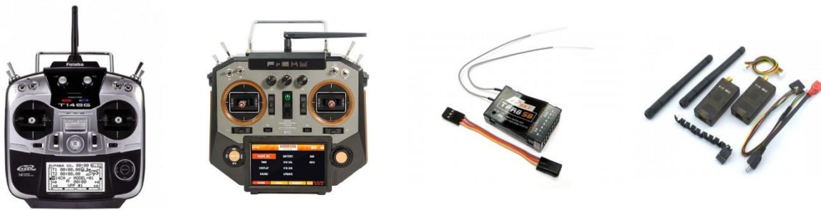
Abbildung 4.19: Gängige RCs von Futaba und FrSky, ein FrSky-Empfänger und ein 433 MHz Telemetrie Set (v.l.n.r.) [156]
