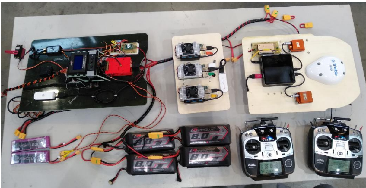
Abbildung 5.7: Gesamte Avionik inklusive Payload und Akkus für das DEMONA-UAV
