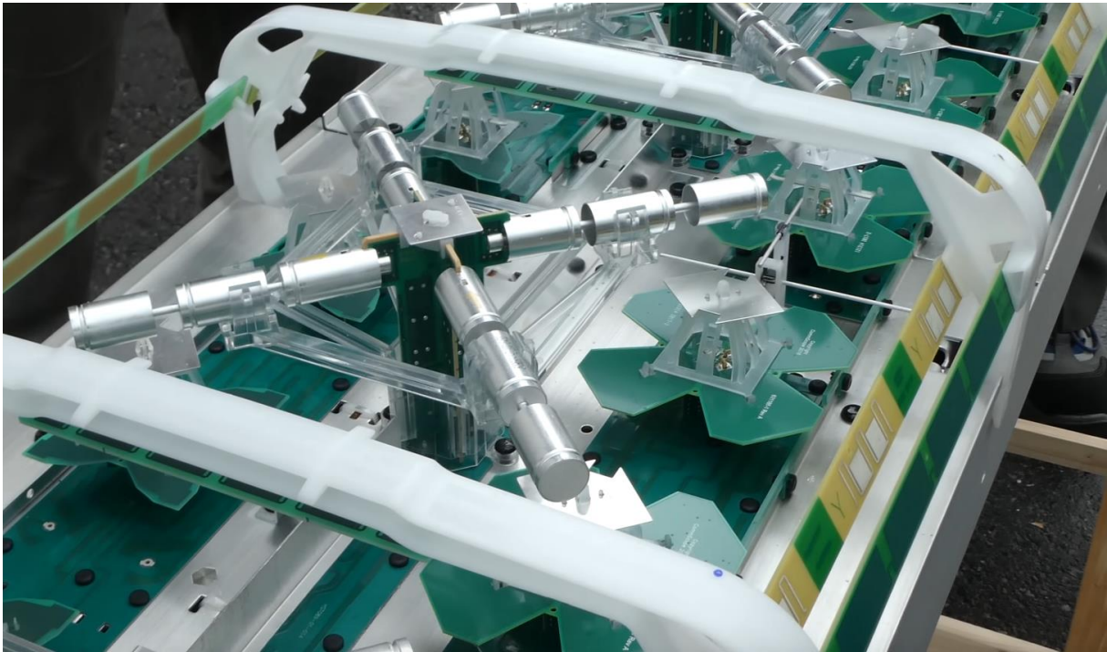
Abbildung 7.4: Aufbau einer 5G Multiband-Antenne vorne [263]
