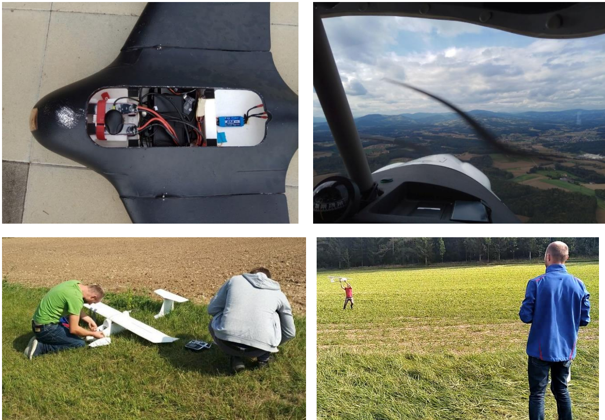
Abbildung 5.23: Messdatenerfassung mittels Smartphones in UAVs sowie dem Leichtflugzeug Icarus C42 (rechts oben)
