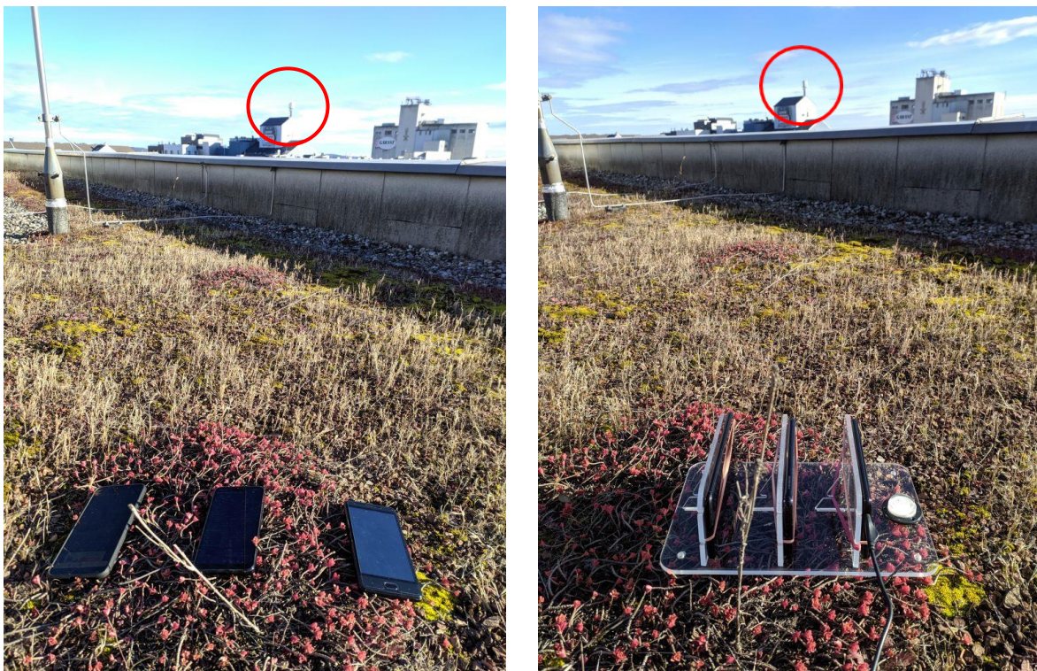
Abbildung 5.21: Stationäre Messung mit drei unterschiedlichen Smartphones im selben Mobilfunknetz
