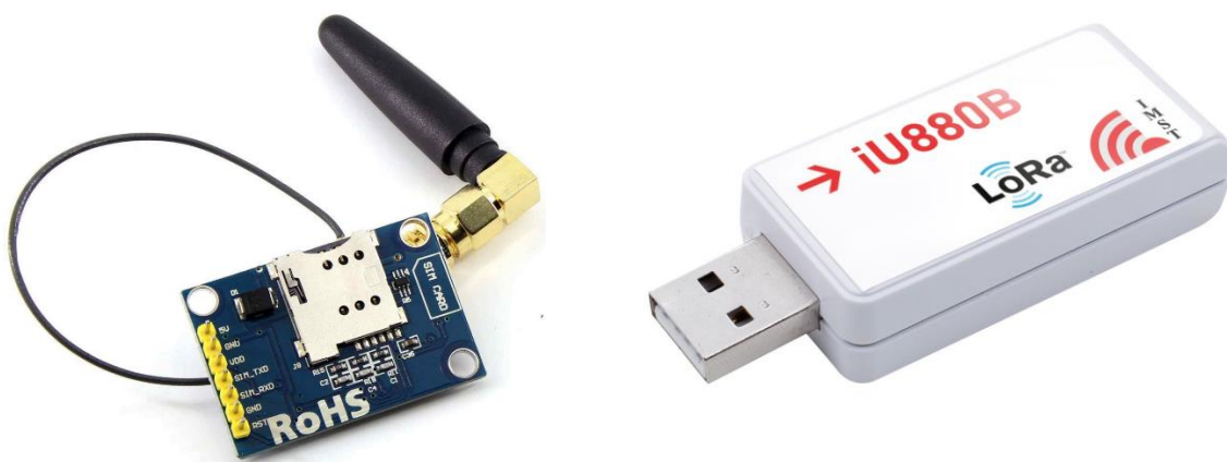
Abbildung 5.2: GSM Modul SIM800L (links) [199] und ein IMST iU880B USB LoRa Dongle [200]
