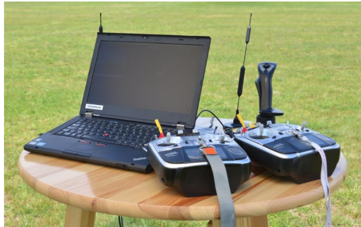
Abbildung 5.6: Futaba T14SG und Aufbau der primären GCS (rechts)
