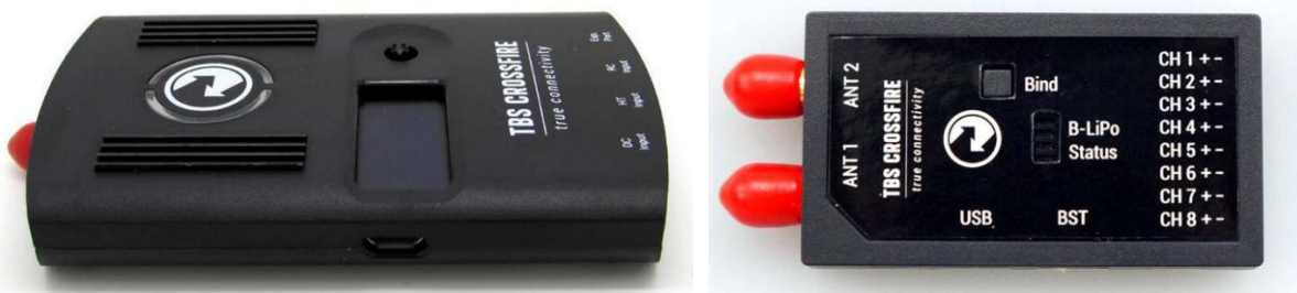
Abbildung 4.18: Team Black Sheep Sender (links) und Empfänger (rechts) [152]
