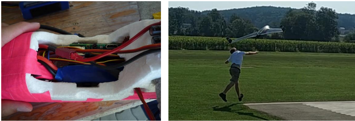
Abbildung 5.26: Vorbereitung eines Easystar-UAVs für den LTE-Direktflug und Start des X8-UAVs für den Fly-by-Wire Flug
