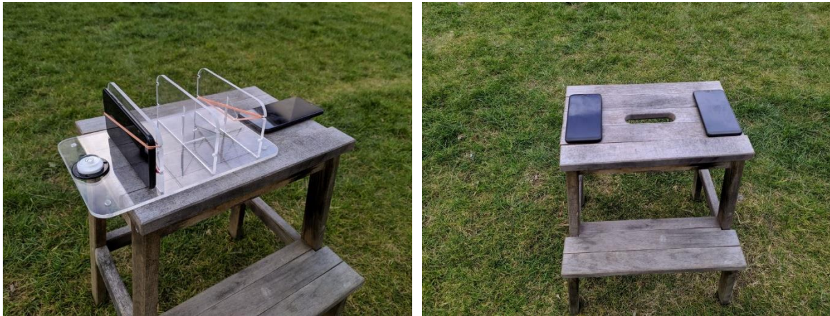
Abbildung 5.22: Stationäre Messungen mit zwei identen Smartphones im selben Mobilfunknetz in unterschiedlicher und gleicher Ausrichtung
