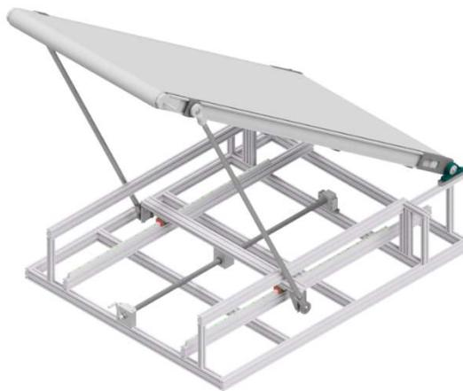
**Abbildung 3-14: Grobkonstruktion Konzept B**
