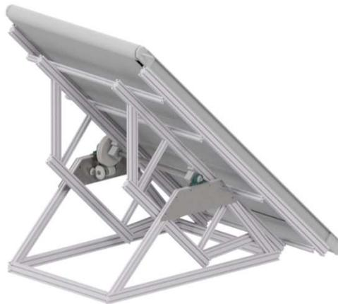
**Abbildung 3-10: Grobkonstruktion Konzept A**
