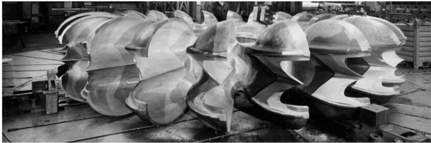
Bild 2.8: Laufrad einer Pelton-Turbine [23, S. 49]
