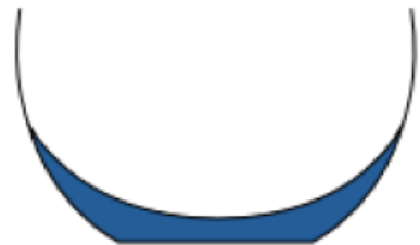
Abbildung 3.11 Schichtenströmung, Strömung an freier Oberfläche [22]
