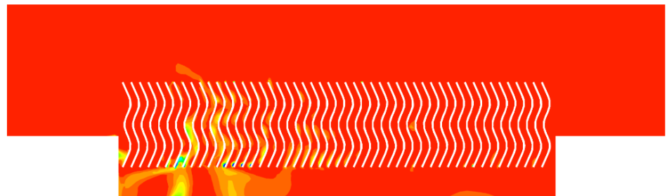
Variante 3 - Eintrittsgeschwindigkeit = 2,6 \text{ m/s}
