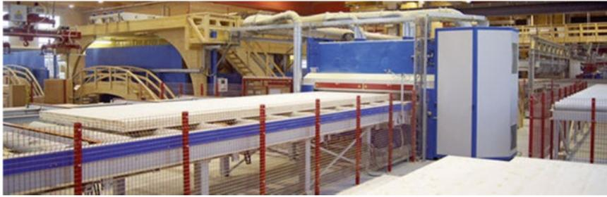
Bild 2.18 Schleifen der Oberfläche <sup>136</sup>
