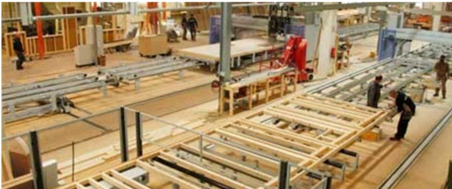
Bild 2.3 Beispiel für eine Fertigungsanlage der Wand- und Dachelemente<sup>41</sup>
