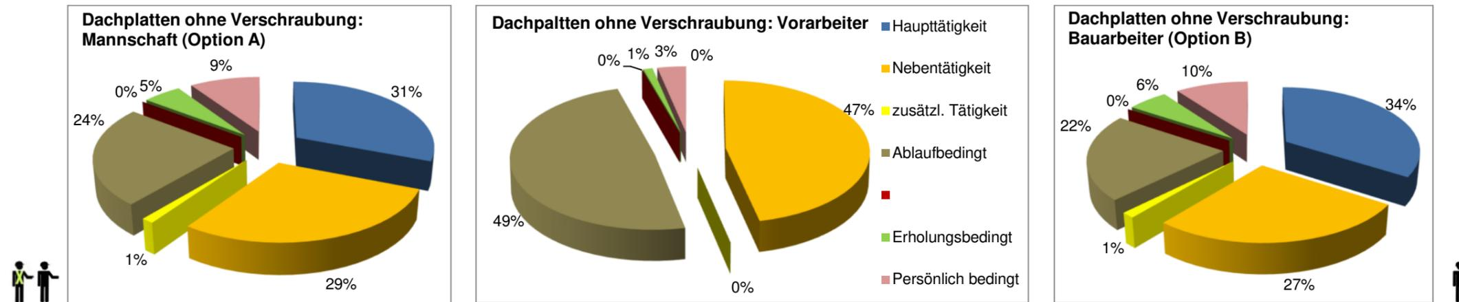
Bild A.79 Dachplatten ohne Verschraubung – Verteilung der Arbeitszeiten unter Berücksichtigung Tätigkeiten am Arbeitstag, die in der Verbindung mit Montage Dachplatten stehen – Variante 3b (exkl. störungsbedingte Unterbrechungen)
