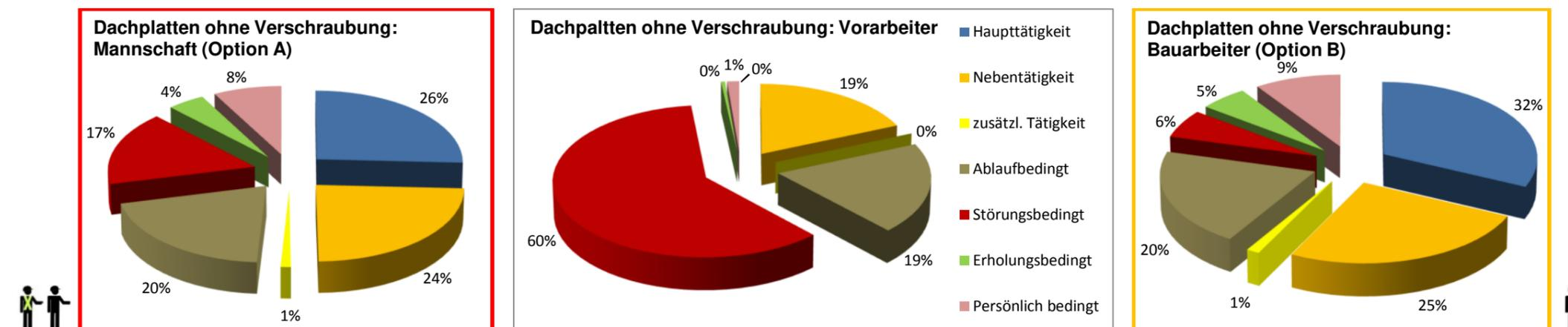
Bild A.78 Dachplatten ohne Verschraubung – Verteilung der Arbeitszeiten unter Berücksichtigung Tätigkeiten am Arbeitstag, die in der Verbindung mit Montage Dachplatten stehen – Variante 2b
