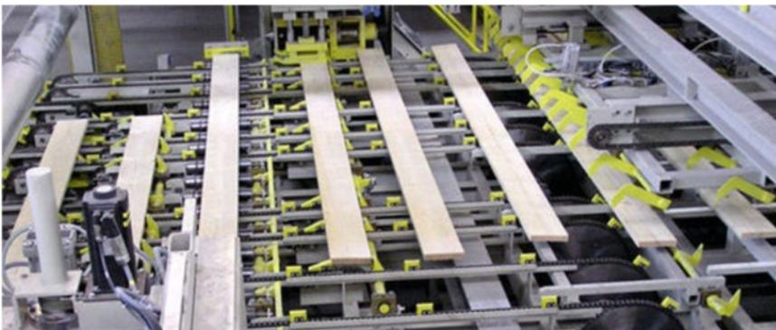
Bild 2.12 Sortierung der vorgehobelten Brettlamellen<sup>125</sup>
