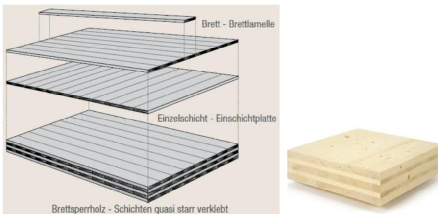
Bild 2.8 Prinzipieller Aufbau von Brettsperrholz aus Brettlamellen<sup>93</sup>
