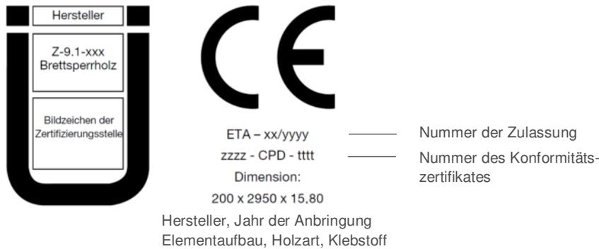
Bild 2.9 Beispiel eines Einbauzeichens ÜA (abZ) und CE-Zeichens (ETA) für ein zugelassenes BSP-Produkt<sup>109</sup>
