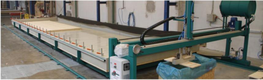
Bild 2.16 Vakuum-Großflächenpresse <sup>132</sup>
