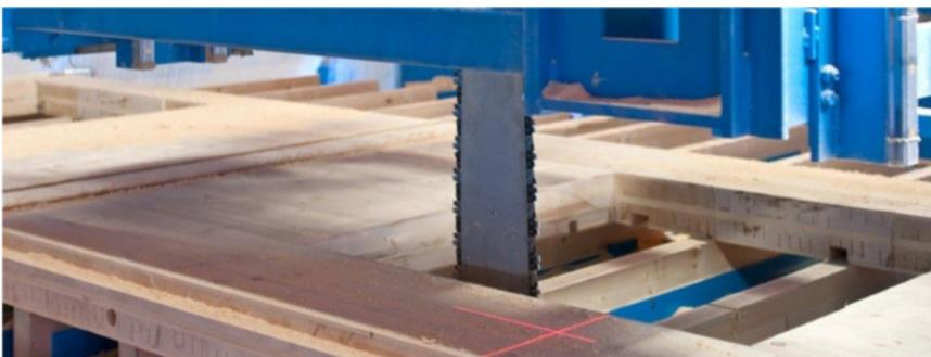
Bild 2.17 Fräsen von Öffnungen <sup>135</sup>
