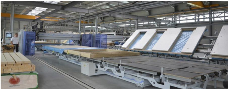
Bild 2.4 Beispiel für Fertighausproduktion mit hohem Vorfertigungsgrad<sup>44</sup>
