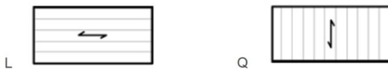
Bild 2.11 Herstellungsbedingte Orientierung der Decklagen eines BSP-Elementes<sup>115</sup>
