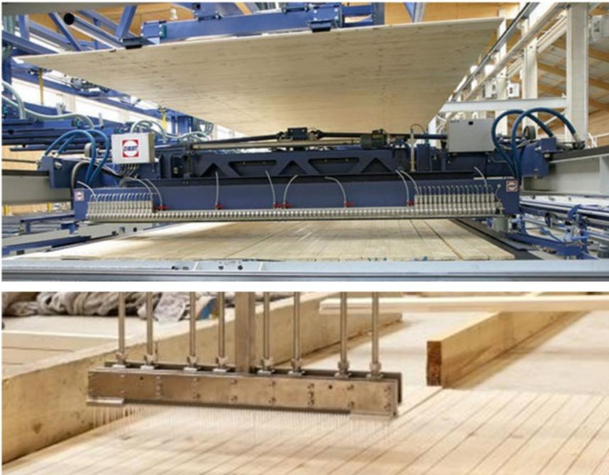
Bild 2.14 Fügen zu Einzelschichten und Beleimungsportal <sup>127 128</sup>
