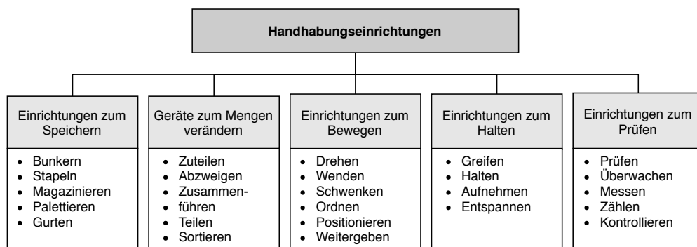
Abbildung 2.9: Gliederung der Funktionen von Handhabungseinrichtungen 45
