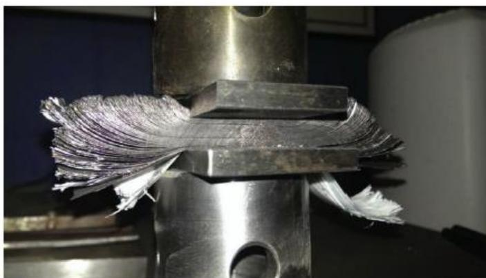
Abbildung 2-5: Uniaxialer Kompressionstest eines ausgerollten Zellwickels [25]
