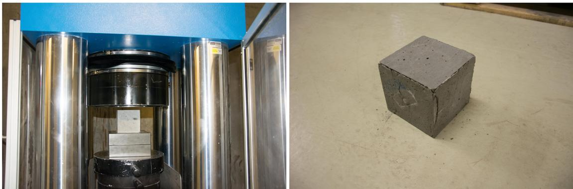
(a) Versuchsaufbau Würfel Druckfestigkeit
