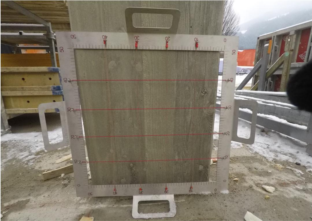
Abb. 144: Ergebnis der Säule 2 direkt nach dem Ausschalen
