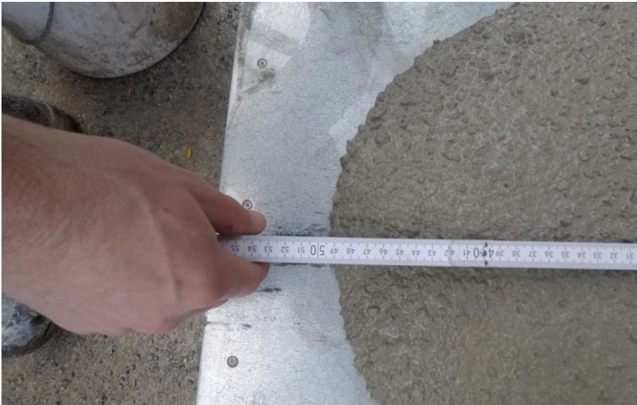
Abb. 138: Ausbreitmaß des Frischbetons der Säulen 1 und 2
