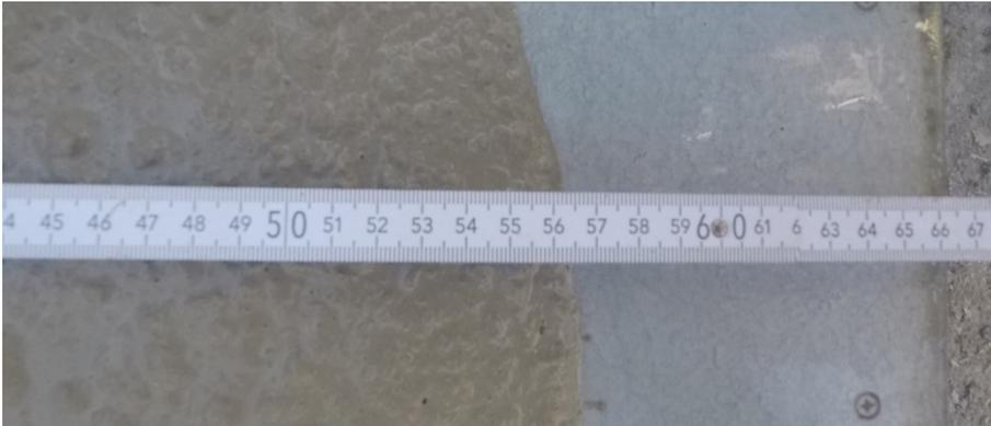
Abb. 192: Ausbreitmaß des Betons von Fassade 1 und 4
