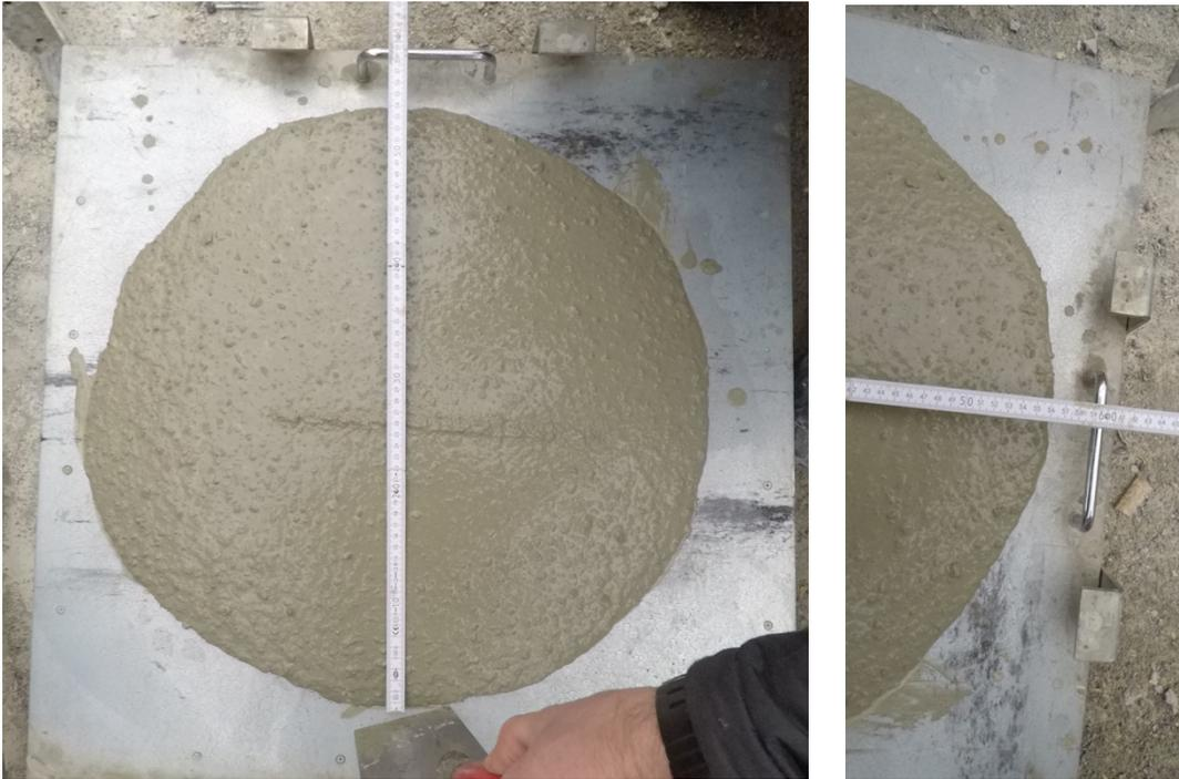
Abb. 152: Ausbreitmaß des Frischbetons der Musterfläche 4 und 5
