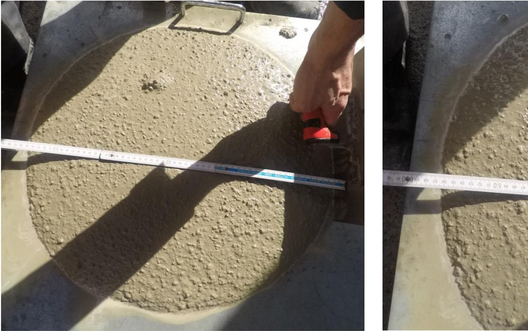
Abb. 79: 2. Ausbreitmaß des Betons der Musterfläche 2
