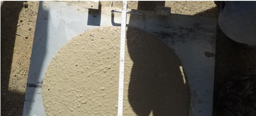
Abb. 111: Ausbreitmaß der Betoncharge 1
