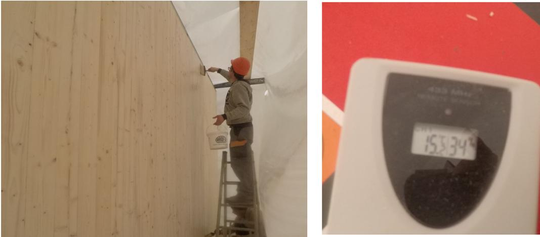
Abb. 207: Verdunstungsmittelauftrag Fassade 2
