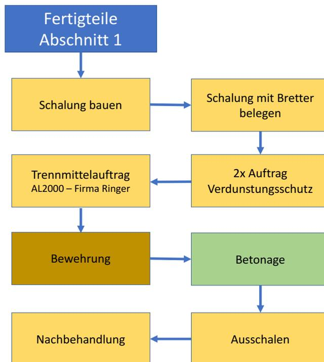
Abb. 304: Herstellungsprozess der Fertigteile Abschnitt 1
