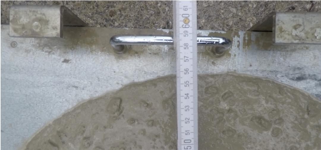
Abb. 347: Ausbreitmaß der Fassade 7 und 9
