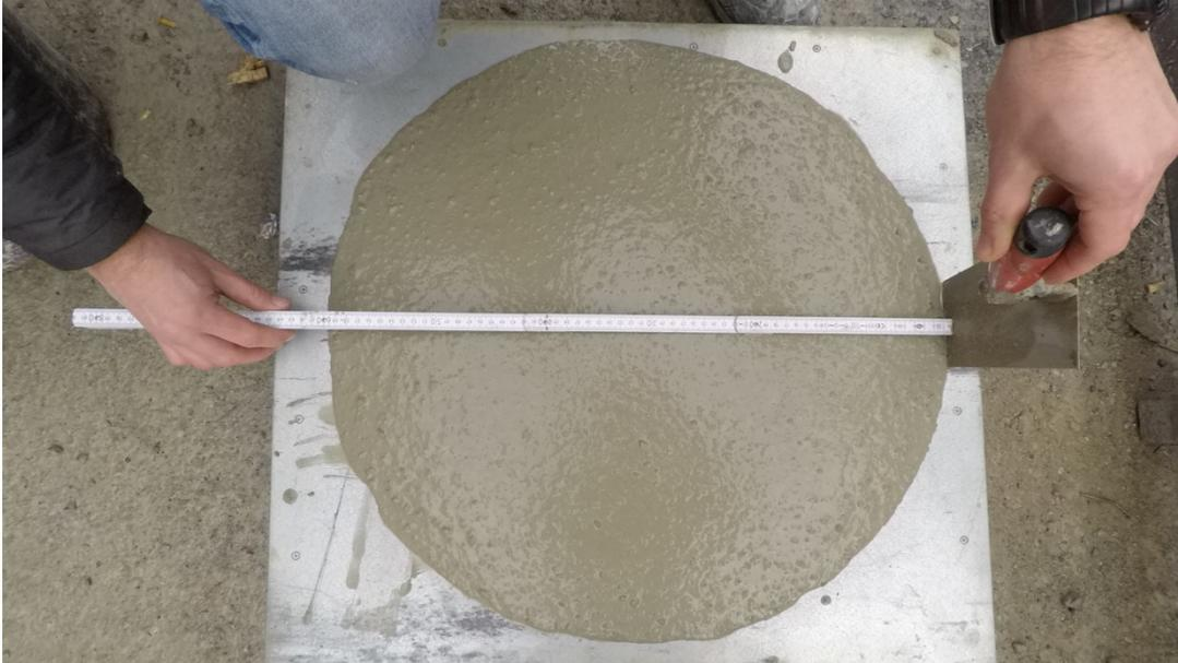
Abb. 110: Ausbreitmaß der Betoncharge 1
