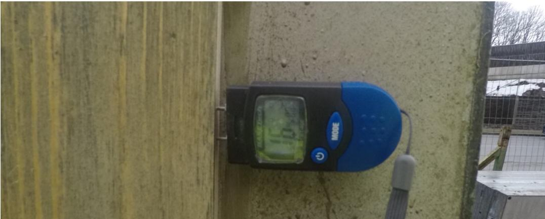
Abb. 52: Holzfeuchte beim Schließen der Schalung
