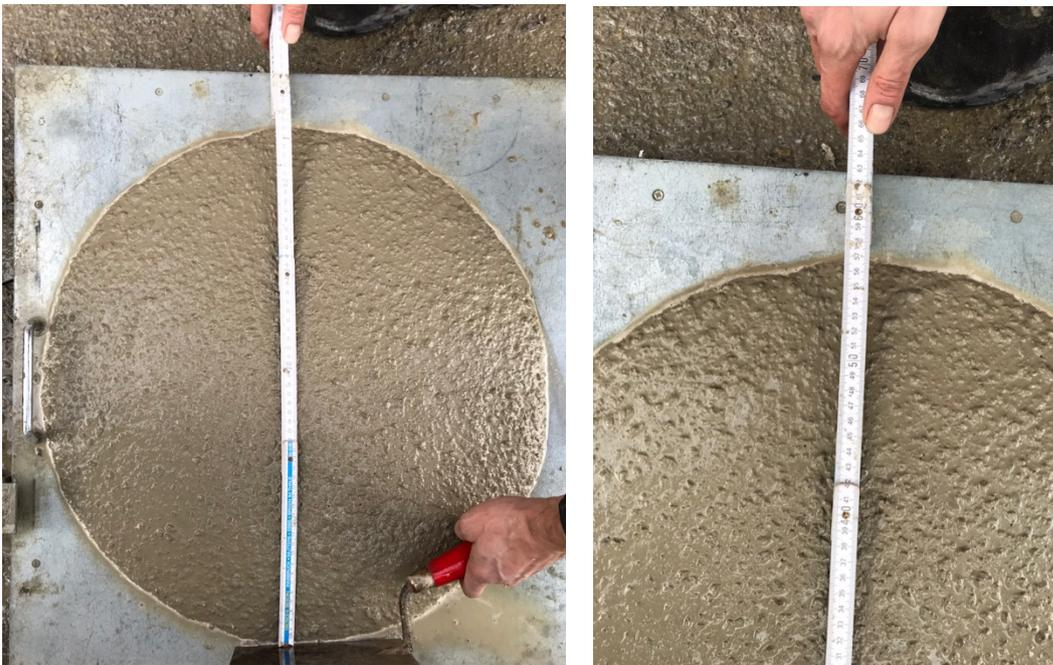
Abb. 100: Ausbreitmaß des Betons der Musterfläche 3
