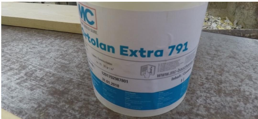
Abb. 22: Trennmittelpaste Ortolan Extra 791 von der Firma MC Bauchemie
