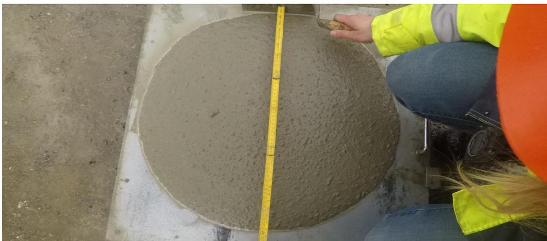
Abb. 229: Ausbreitmaß des Betons von Fassade 3
