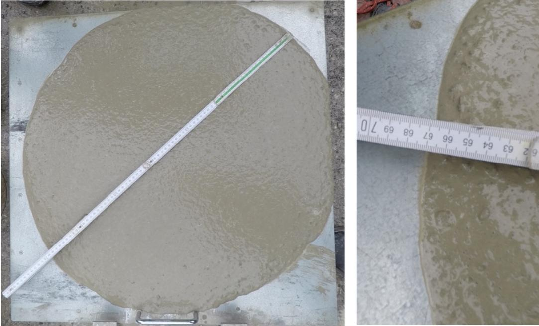
Abb. 376: Ausbreitmaß der Betoncharge 2
