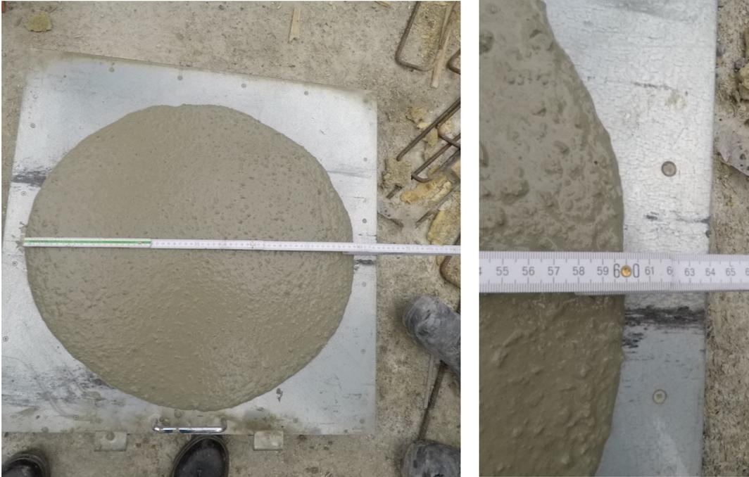
Abb. 213: Ausbreitmaß des Betons der Fassade 2
