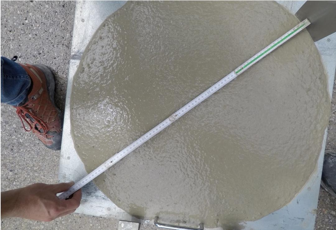
Abb. 375: Ausbreitmaß der Betoncharge 1
