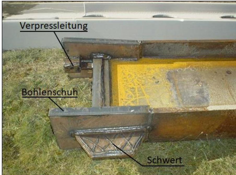
Abbildung 4.10 Rüttelbohle mit Bohlenschuh, Schwert und Verpressleitungen 116
