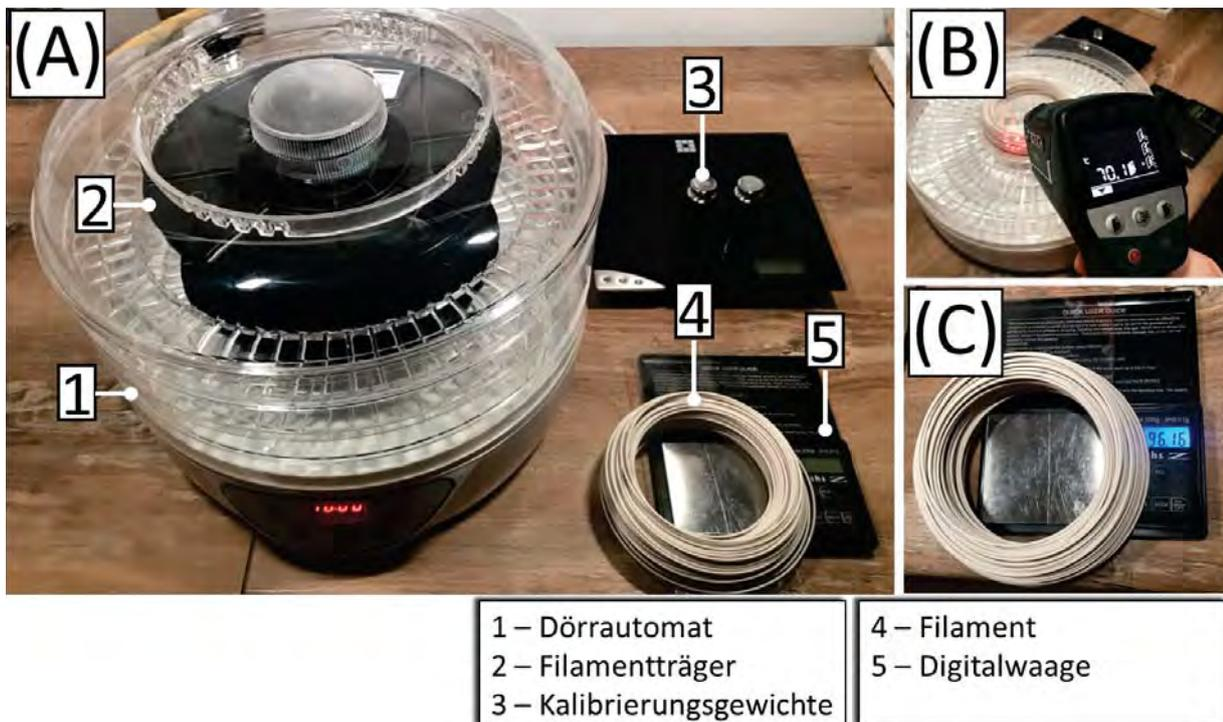
Abbildung F.5: Modifizierter Dörrautomat zur Trocknung des Filaments mit digitaler Waage. (A) Überblick der verwendeten Geräte, (B) Temperaturmessung des zu trocknenden Filaments mittels Infrarotpistole, (C) Gewichtsmessung mit Digitalwaage.
