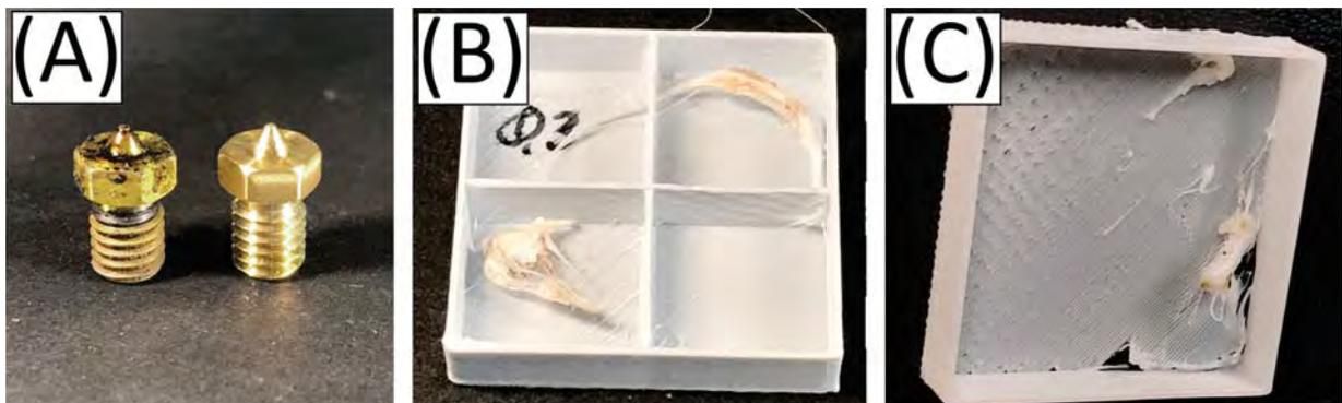
Abbildung F.44: Verunreinigung der Düse beim FDM-Druckverfahren. (A) Vergleich von 0,25 mm verunreinigter Düse (links) und neuwertiger Düse (rechts), (B) Filamentablagerungen im Testwürfel mit Stützstellen, (C) inkonsistente Schichtung des Filaments beim Testwürfel.
