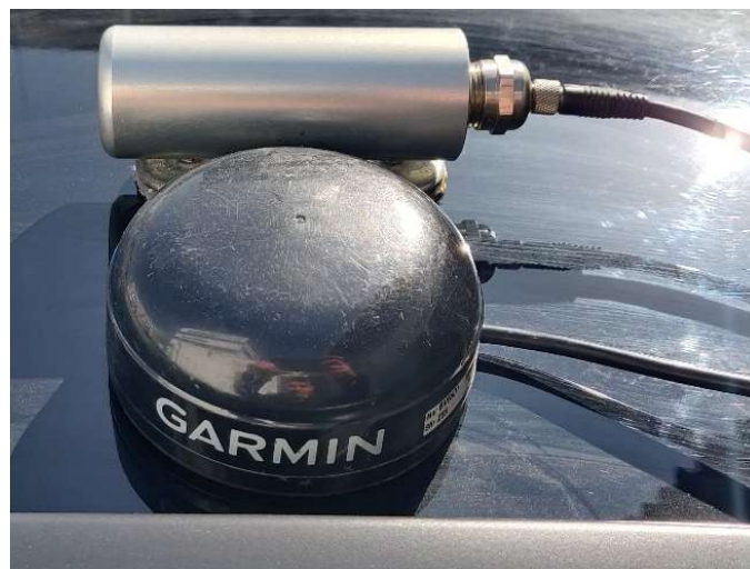
Abbildung 3-6: Wetter- und GPS-Station
