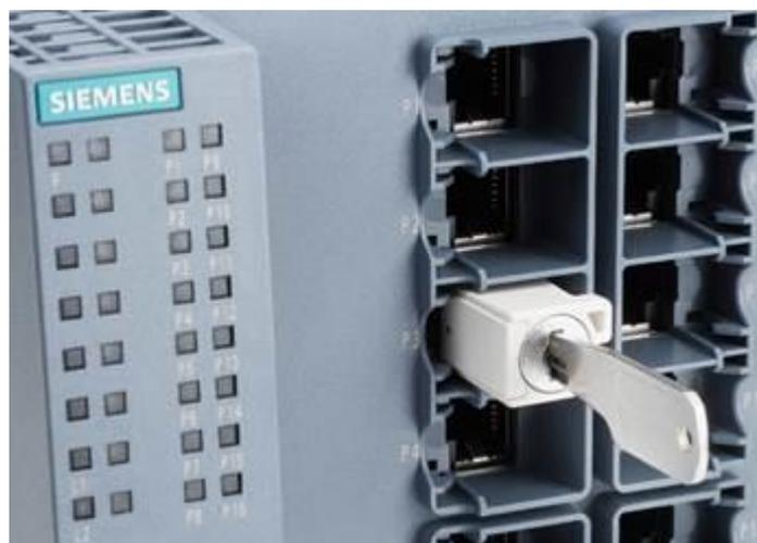
Abbildung 42: Siemens Port Lock, Quelle: Siemens AG (2010), Onlinequelle [09.05.2021]
