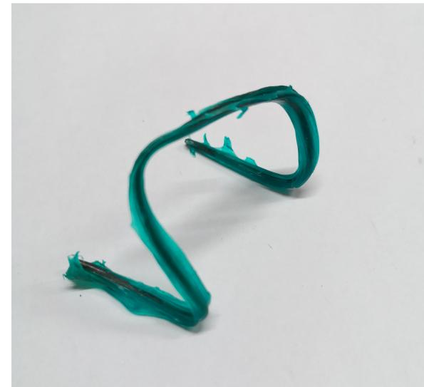
Abb. 221. Draht mit Alginatbeschichtung
