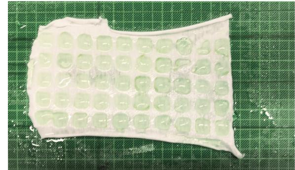
Abb. 228. Alginat & Stoff mit  $\text{CaCl}_2$  besprüht
