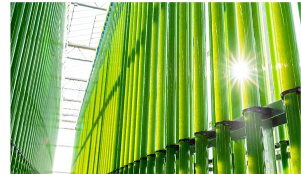
Abb. 48. Industrielle Photobioreaktor Anlage
