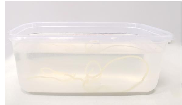
Abb. 89. Extrudiertes Garn in CaCl<sub>2</sub>-Bad
