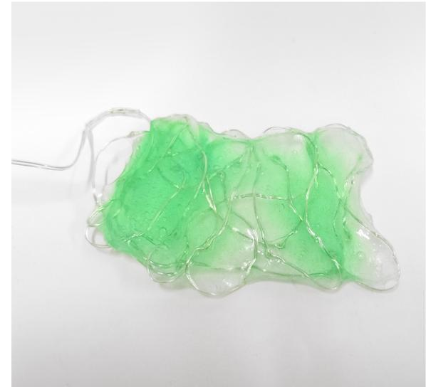
Abb. 222. Alginat mit Leuchtdraht
