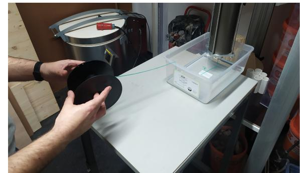
Abb. 128. Aufwickeln des Garns auf Garnrolle
