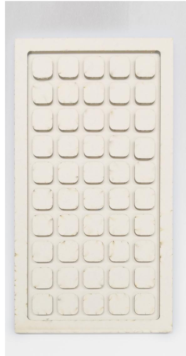
Abb. 148. Gusstafel aus Finnpappe
