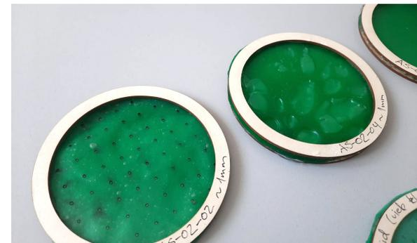
Abb. 202. Akustikprobe perforiert
