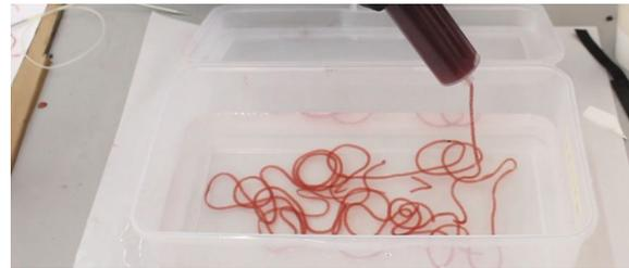
Abb. 38. Extrusion von Alginat
