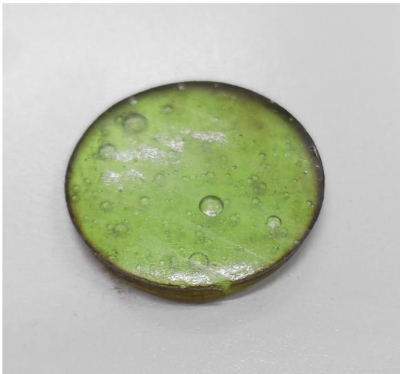
*Abb. 199. 2,5mm Alginatfolie geschnitten im Lasercutter*
