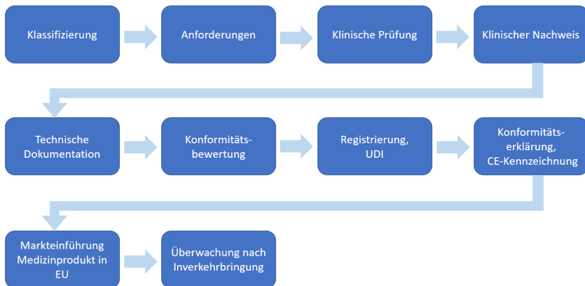
Abbildung 2: Schematische und vereinfachte Darstellung der Tätigkeiten bis zum Inverkehrbringen und der Überwachung eines Medizinprodukts
