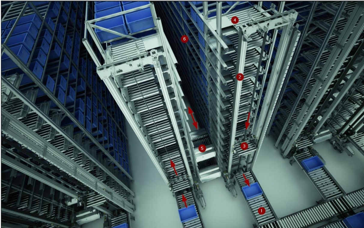
Abbildung 4: Darstellung eines 1D-OSR-Shuttle-Systems (1... Förderstreckenansbindung, 2... Lift, 3... Lastaufnahmemittel, 4... Zwischenpuffer, 5... Shuttle, 6... Regal) (Foto: KNAPP Marketing)
