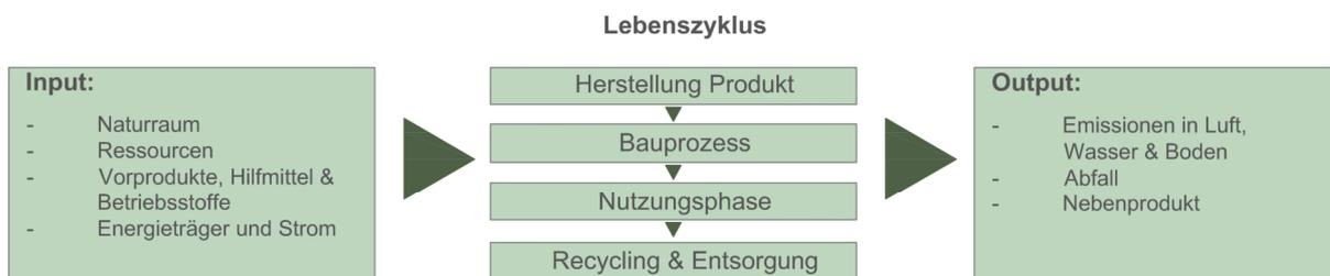
Bild 2.10 In- und Output-Ströme eines Gebäudelebenszyklus<sup>130</sup>
