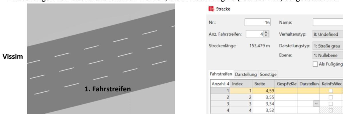
**Abbildung 26: Fahrstreifenbreiten in Vissim
