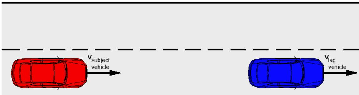
**Abbildung 52: Annäherungsprozess eines menschlichen Fahrers bzw. automatisierten Fahrzeugs an ein Vorderfahrzeug**
