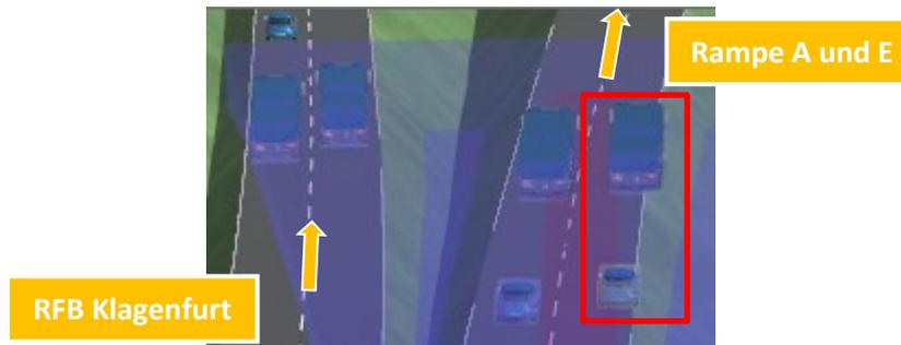
**Abbildung 40: Fahrzeugreifen schweben in der Luft während der Co-Simulation (Blick in Fahrtrichtung)**
