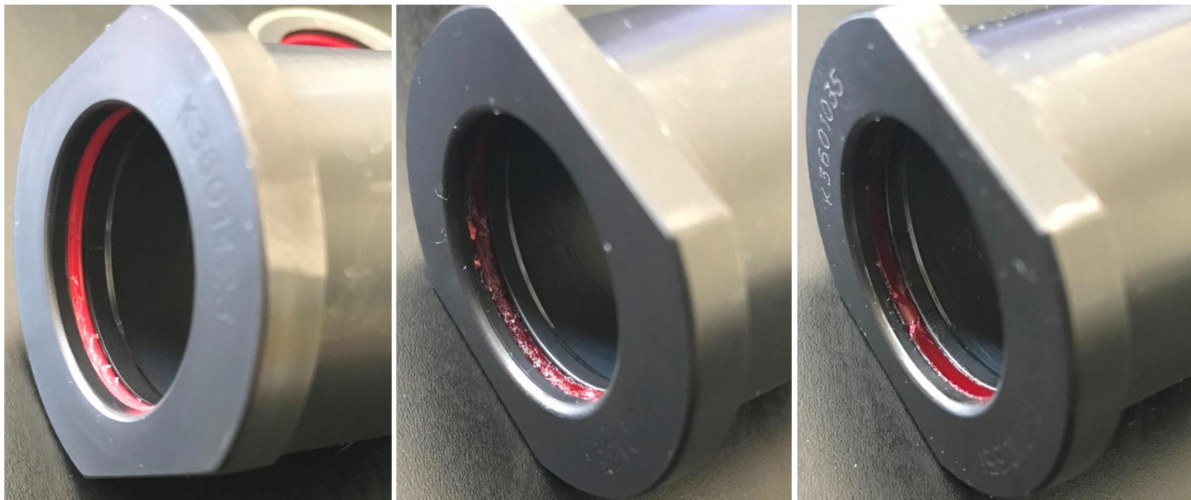
Abbildung 3-40: Schadensbilder: (a) nach 3.500 Zyklen einer Kupplung mit Q = 60 l/min, (b) nach 4.500 Zyklen und einer Größe von 250 l/min und (c) nach 1.500 Kuppelvorgängen einer Kupplung mit Q = 250 l/min
