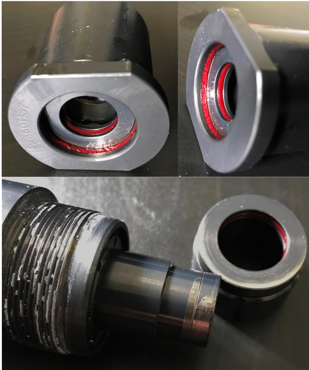
Abbildung 3-37: Schadensbilder an der ersten ausgefallenen Kupplung mit Q = 250 \text{ l/min}
