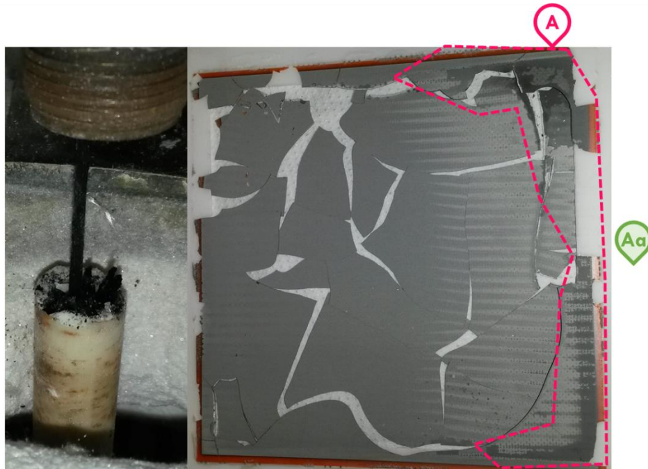
Abbildung 5-58 Anodenauslassleitung mit Kohlenstoffablagerungen (links) und Anodenseite der Zelle nach dem Versuch
