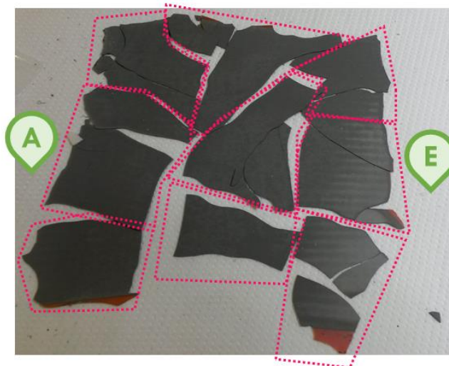
Abbildung 4-16 Aufbereitung einer Zelle für die mikroskopische Untersuchung
