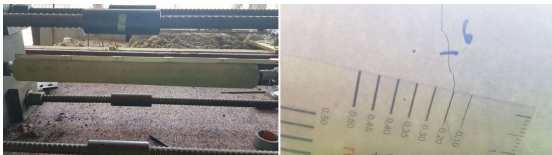
Abb. 37: Erste Laststufe F=250\text{ kN} - Rissbreiten zwischen 0,1-0,2 mm; Links: Prüfkörper; Rechts: Maßgebender Riss mit 0,2 mm
