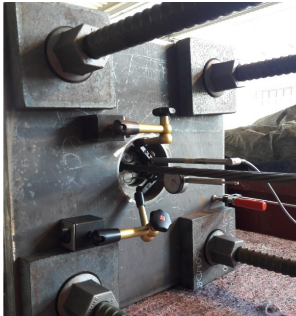
Abb. 31: An einer Keilscheibe montierter Wegaufnehmer
