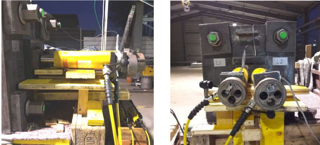
Abb. 25: Aufbau für das Aufbringen der Vorspannkraft der Litzen
