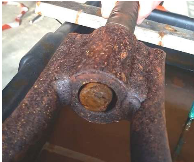
Abb. 44: Vorversuch - korrodierter verschraubter Bügelanschluss
