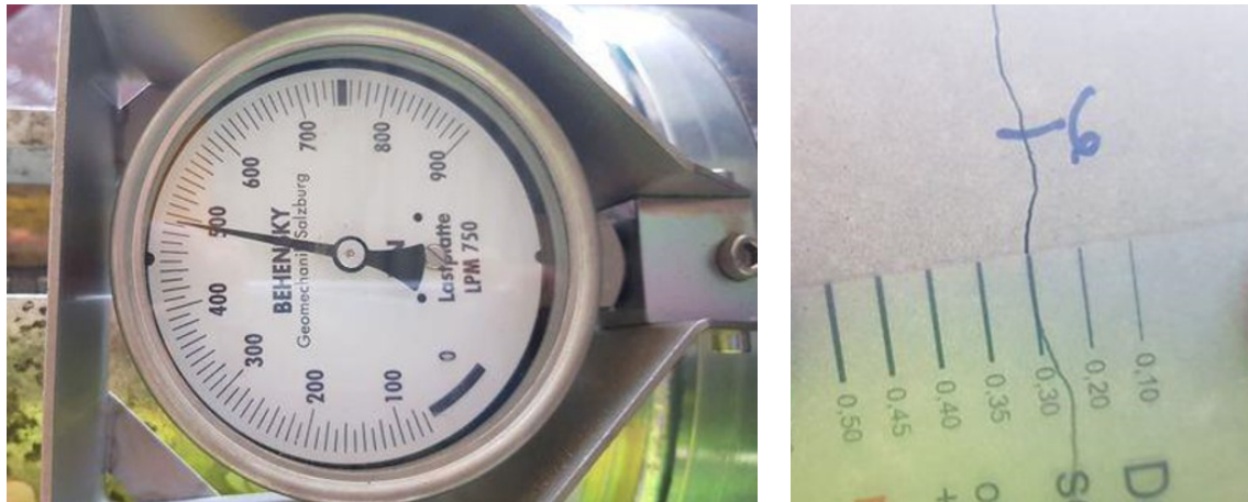
Abb. 38: Dritte Laststufe F=495 kN - Rissbreiten zwischen 0,1-0,3 mm; Links: Manometer LP; Rechts: Maßgebender Riss mit 0,3 mm
