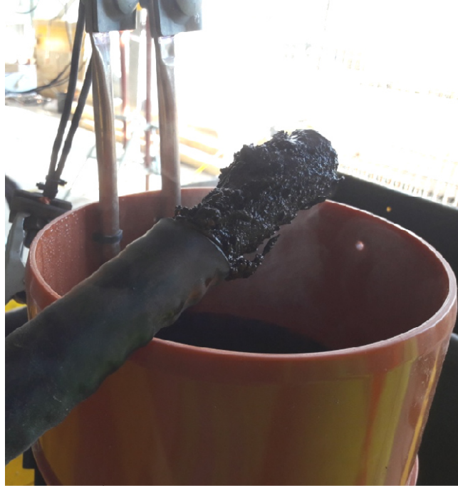
Abb. 43: Vorversuch - korrodierter Ankerstab
