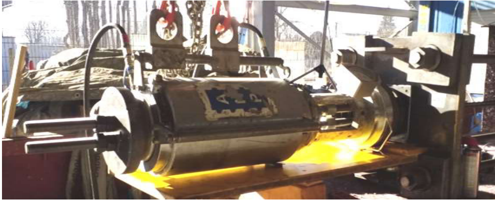
Abb. 29: Pressenaufbau zum Abheben über die neue Kupplungskonstruktion
