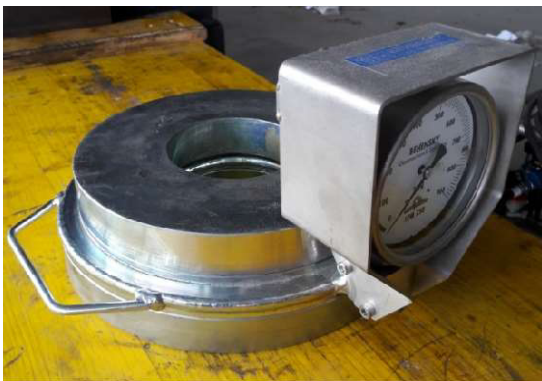
Abb. 7: Links: Hydraulische Lastplatte mit Manometer (Fa. Behensky); Rechts: Hydraulischer Ankerkraftgeber mit elektronischem Aufnehmer (GLÖTZL Gesellschaft für Baumesstechnik mbH, 2019)
