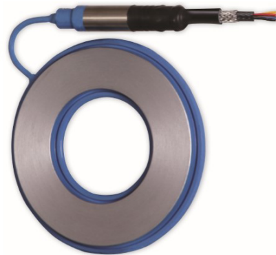
Abb. 7: Links: Hydraulische Lastplatte mit Manometer (Fa. Behensky); Rechts: Hydraulischer Ankerkraftgeber mit elektronischem Aufnehmer (GLÖTZL Gesellschaft für Baumesstechnik mbH, 2019)
