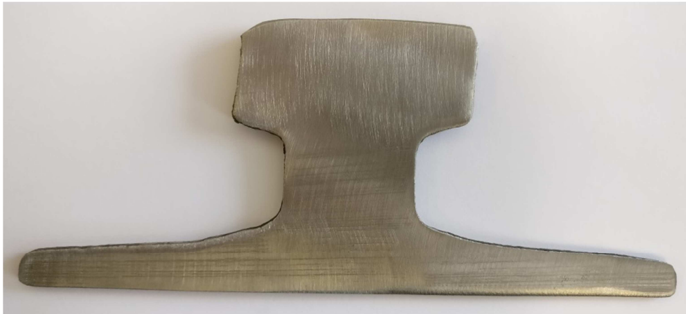
Abbildung 4.7: Abgenutzte Schiene (Foto: Kiem, März 2019)
