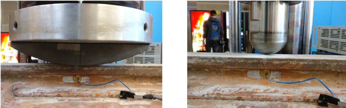
Abbildung 5.7: Belastung mittels Kranrad (links), Belastung mittels Laststempel (rechts) (Foto: Kiem, April 2019)
