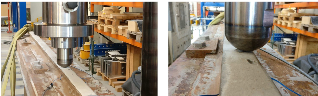
Abbildung 5.5: Versuchsaufbau mit Laststempel zentrisch (links) und mit Laststempel exzentrisch (rechts) (Foto: Kiem, April 2019)
