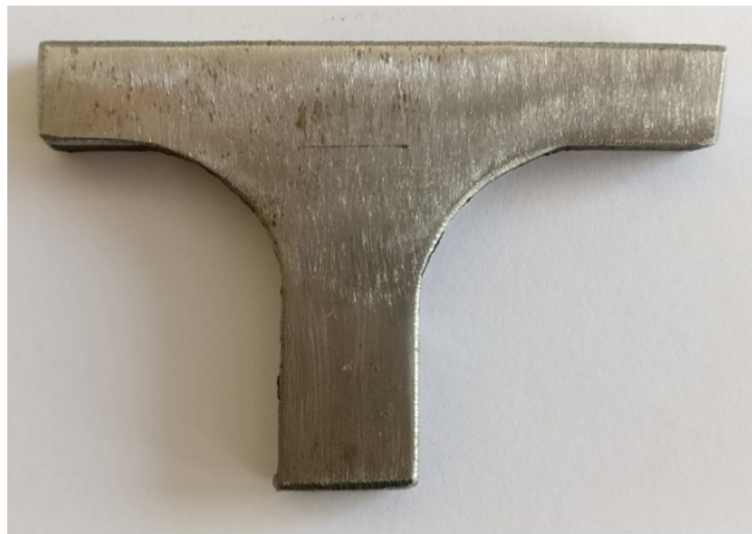
Abbildung 4.17: Verbindung Obergurt mit Steg (Foto: Kiem, März 2019)
