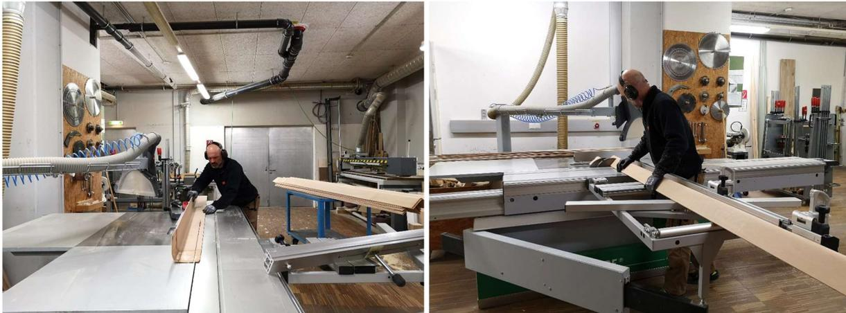
**Abbildung 7-6: Zuschneiden der Winkelprofile**
