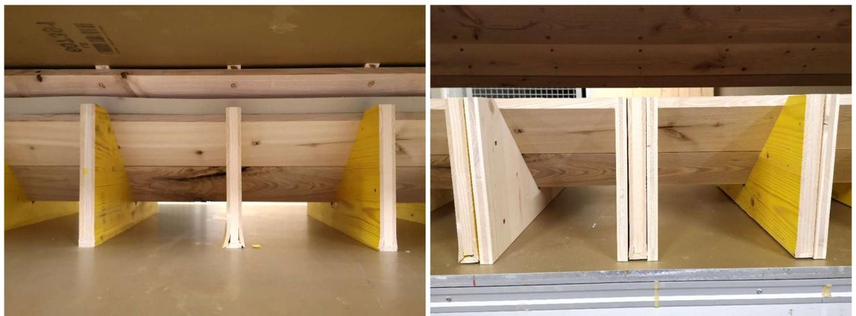
**Abbildung 7-8: Schädigung der Pressform und Verstärkung**
