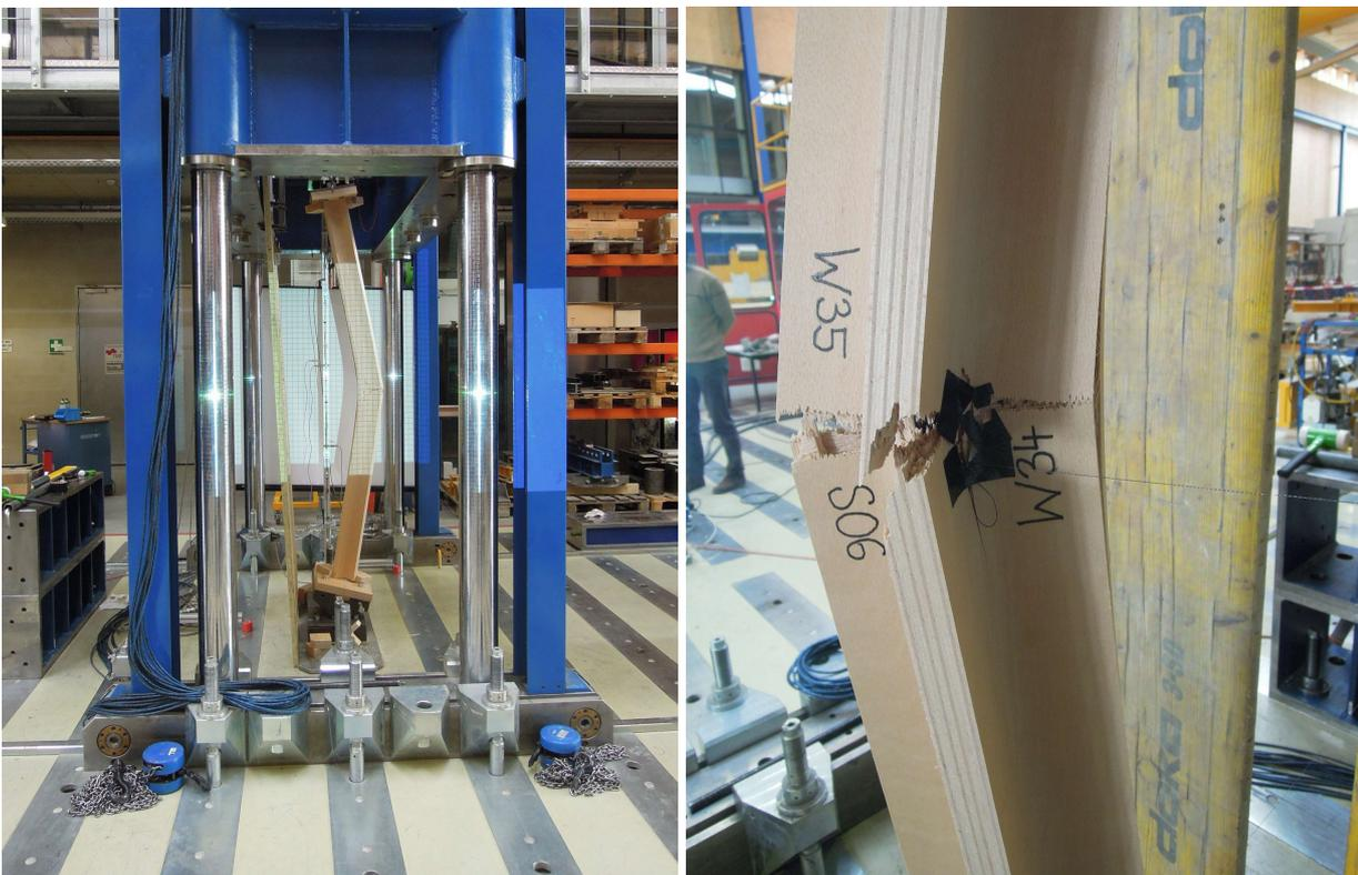
*Abb. Anhang 10-97: verformte Stütze (links) und Bruchstelle (rechts) des Prüfkörpers S06*
