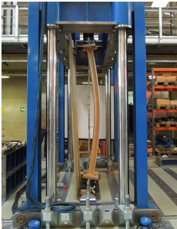
*Abb. Anhang 10-101: verformte Stütze des Prüfkörpers S10*
