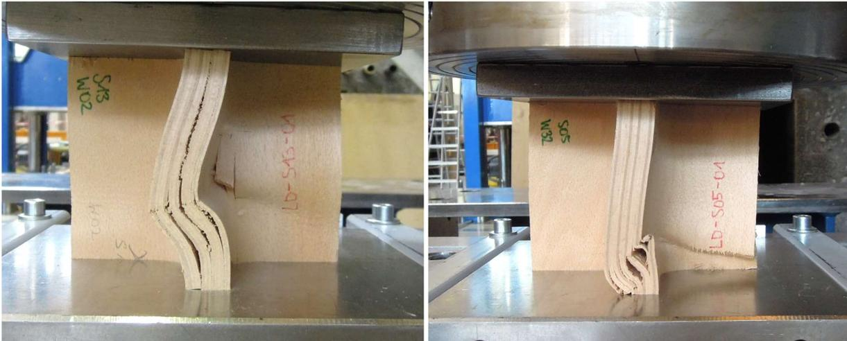
Abbildung 8-10: Beulen in Schenkelmitte (links) und am Auflager (rechts)
