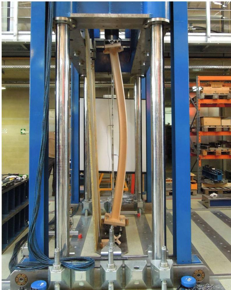
*Abbildung 9-7: Verformungen kurz vorm Versagen der Stütze*
