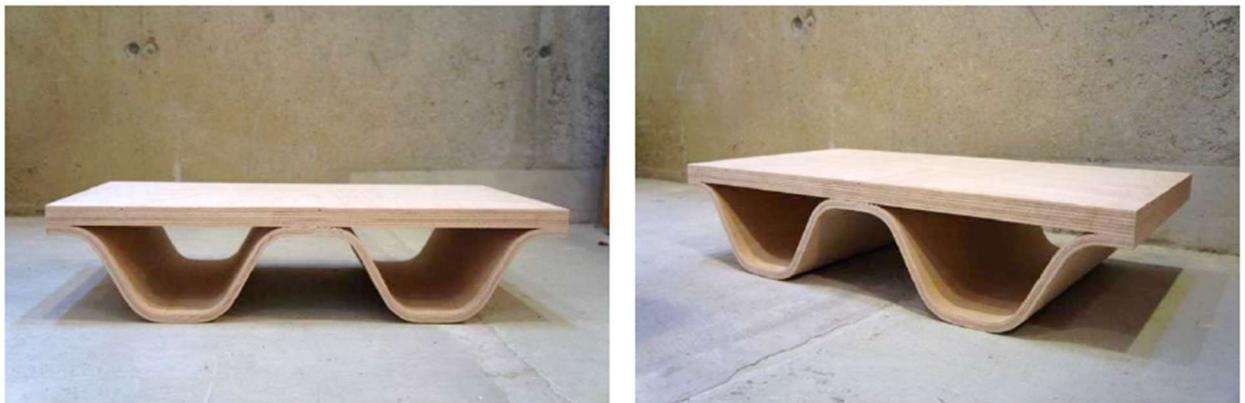
**Abbildung 5-14: Trapezprofil mit Deckplatte aus Buchensperrholz [33]**
