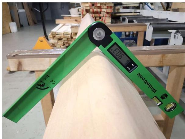
Abbildung 7-14: digitales Winkelmessgerät zur Messung an der Außenseite des Winkelprofils
