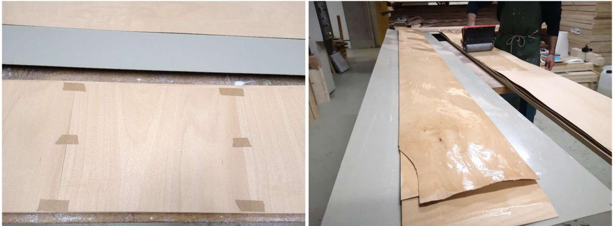
**Abbildung 7-3: Verkleben der Querlagen mit Papierklebeband (links); Klebstoffauftrag mittels Leimwalze (rechts)**
