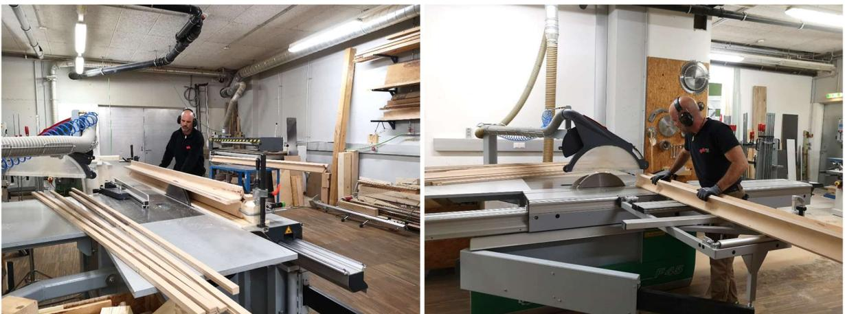
**Abbildung 7-12:** Schneiden der Stützen
