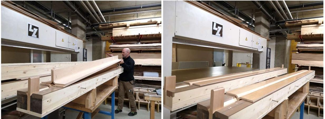
**Abbildung 7-11:** Herausnehmen der T-Profile und Herstellung der zweiten Klebefuge
