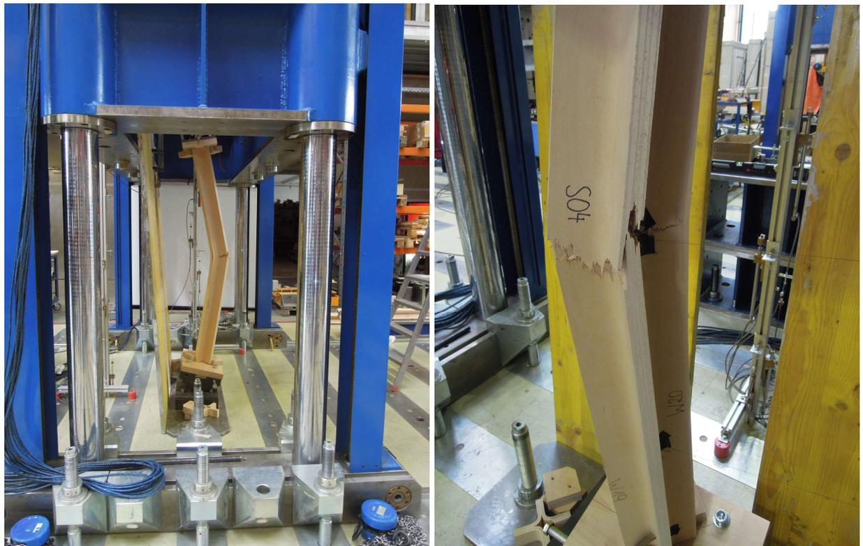
*Abb. Anhang 10-95: verformte Stütze (links) und Bruchstelle (rechts) des Prüfkörpers S04*
