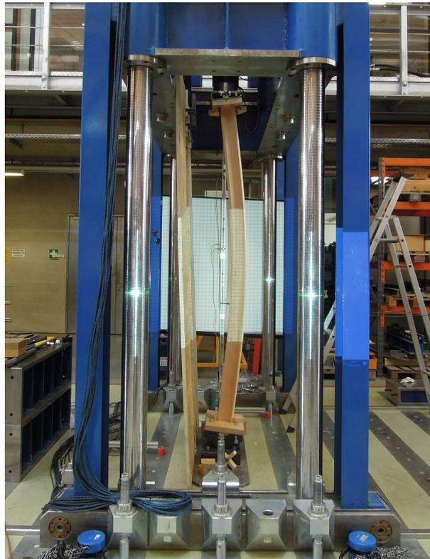
*Abb. Anhang 10-98: verformte Stütze des Prüfkörpers S07*
