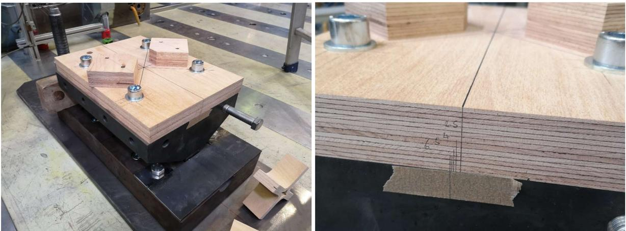
**Abbildung 7-18: Auflagerplatte unten exzentrisch eingebaut**
