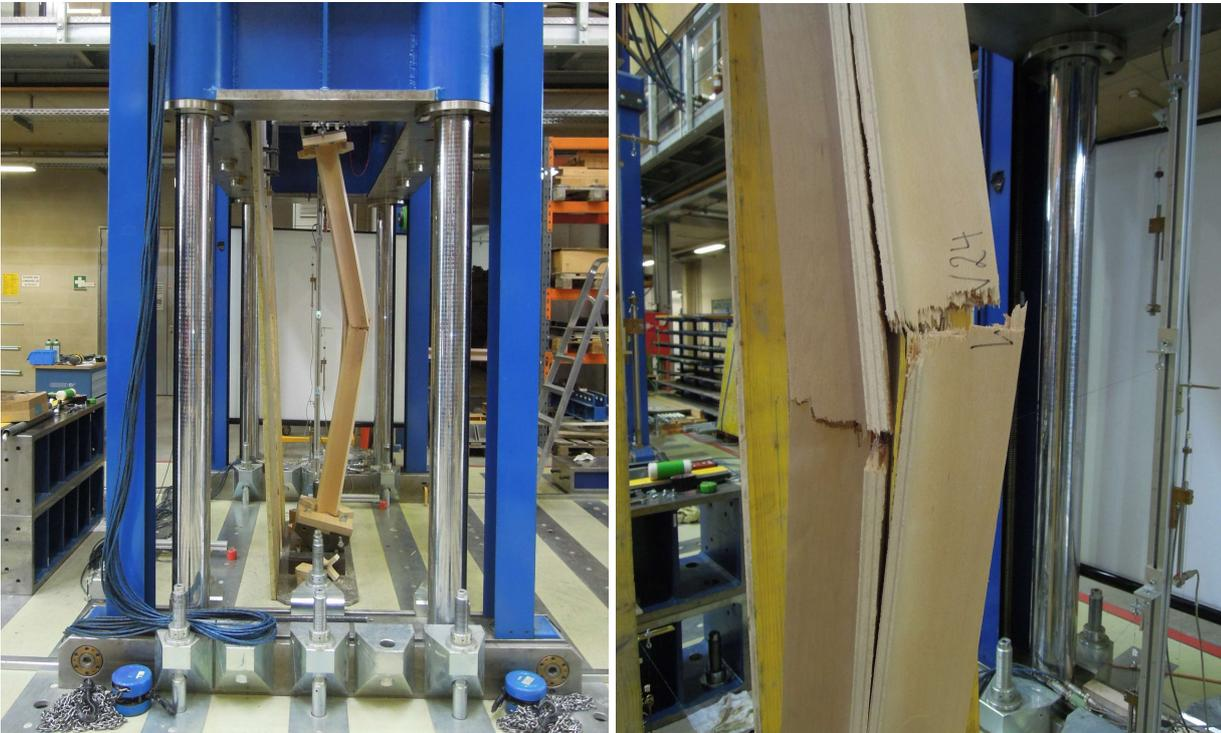
*Abb. Anhang-10-92: verformte Stütze (links) und Bruchstelle (rechts) des Prüfkörpers S01*
