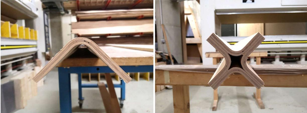
Abbildung 7-13: fertiger Winkel und fertige Stütze
