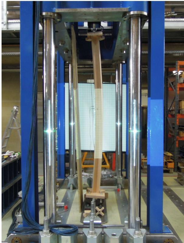
*Abb. Anhang 10-100: verformte Stütze des Prüfkörpers S09*
