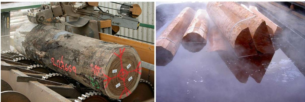
Abbildung 3-3: Entrinden und Ablängen (links) [13]; Dämpfbecken (rechts) [14]
