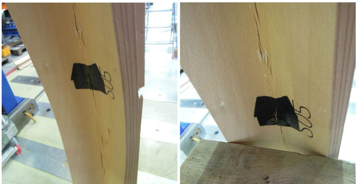
**Abbildung 9-9: Ausweichen des Querschnitts des Prüfkörpers S05**
