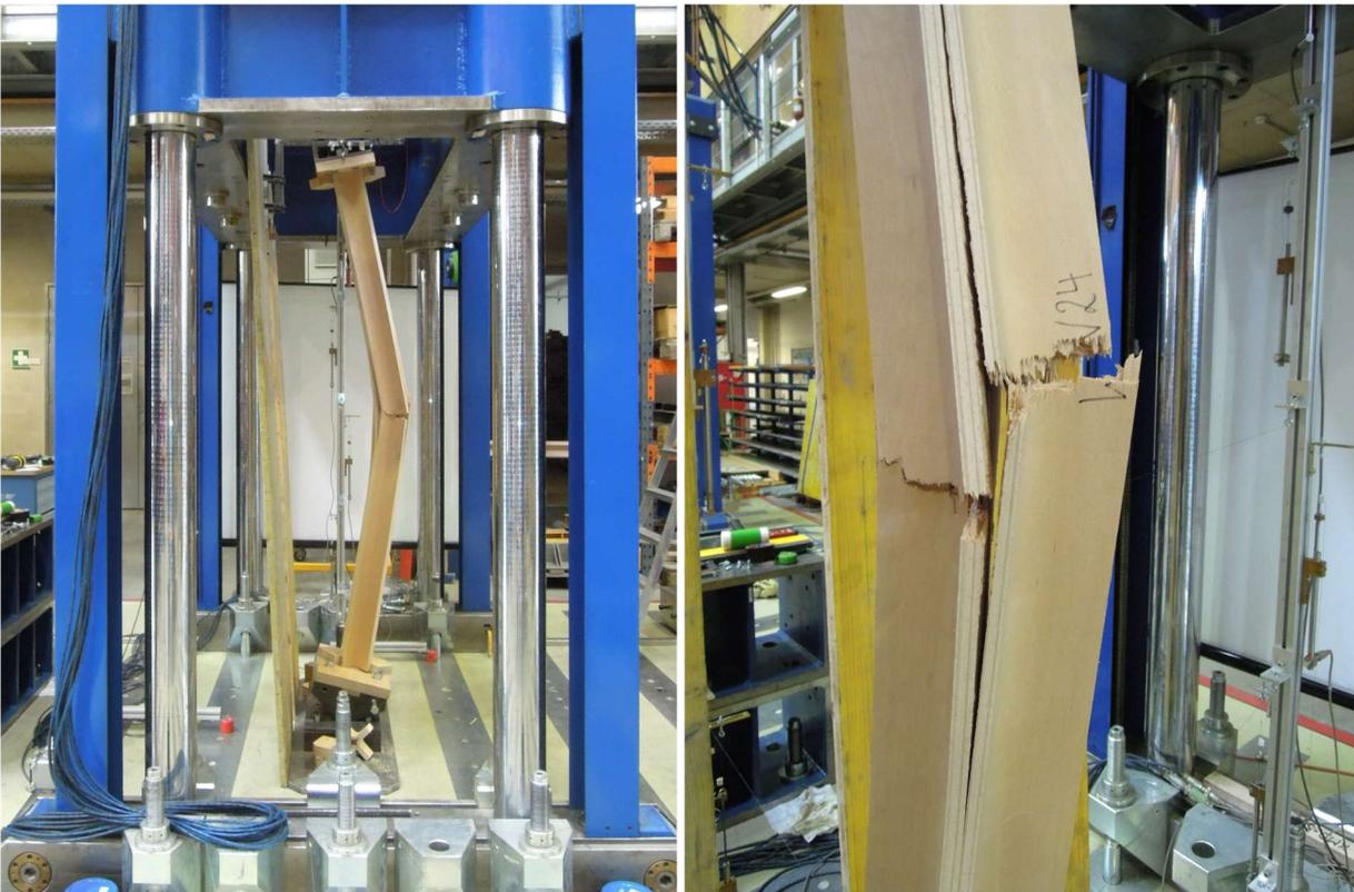
**Abbildung 8-15: Bruchbild des Probekörpers S01**
