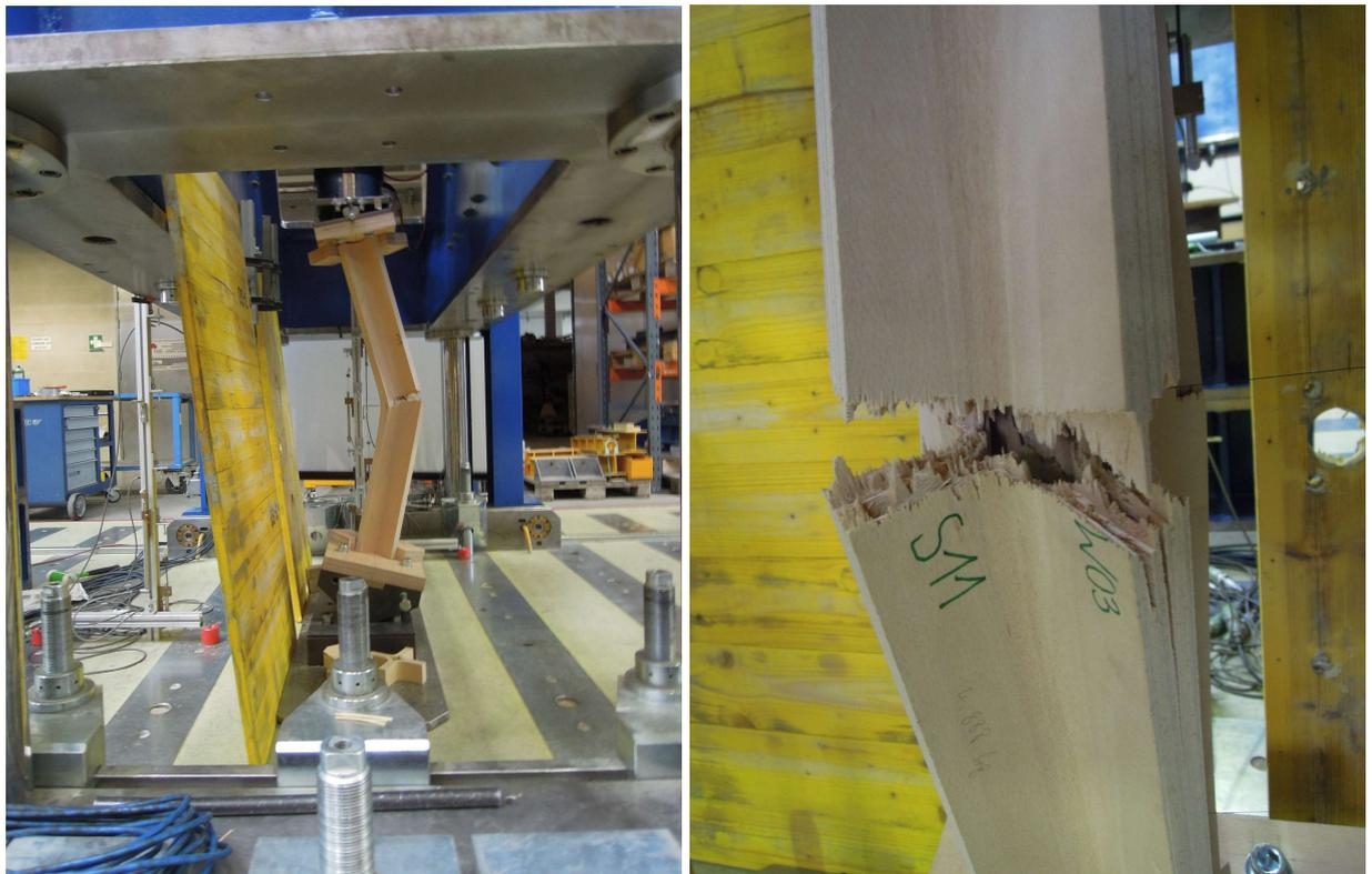
*Abb. Anhang 10-102: verformte Stütze (links) und Bruchstelle (rechts) des Prüfkörpers S11*
