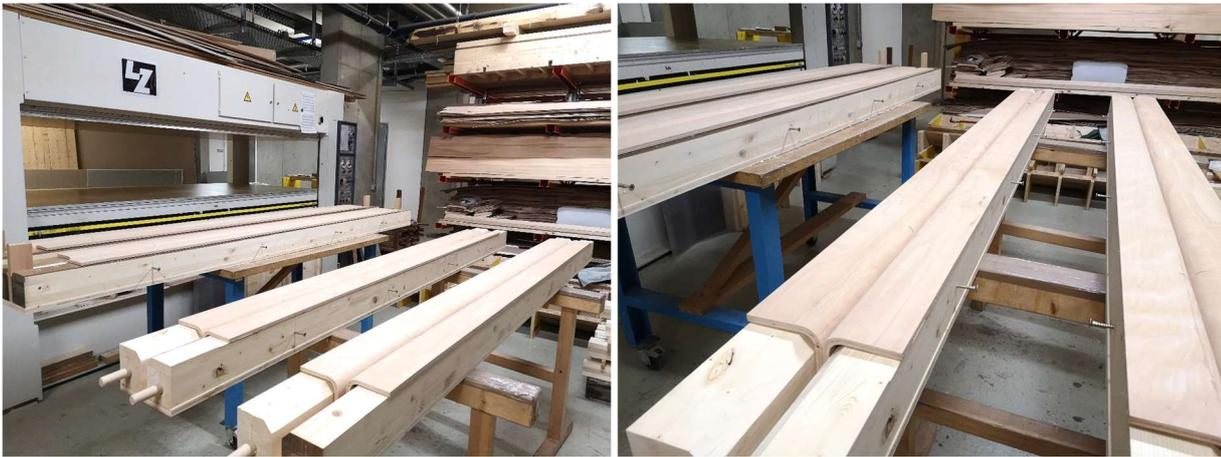
*Abbildung 7-9: Schablone zur Herstellung der Stützen*
