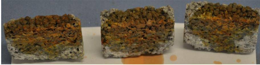
Abb. 5-30: Drainbeton mit Indikatorlösung nach 14 Tagen Wasserlagerung
