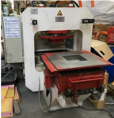
Abb. 3-6: Betonplattenpresse
