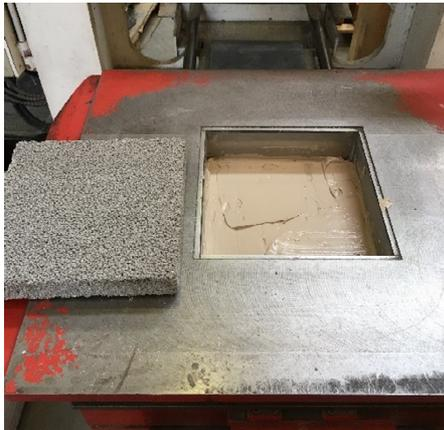
Abb. 3-7: Töpfertonmischung in Betonplattenpresse
