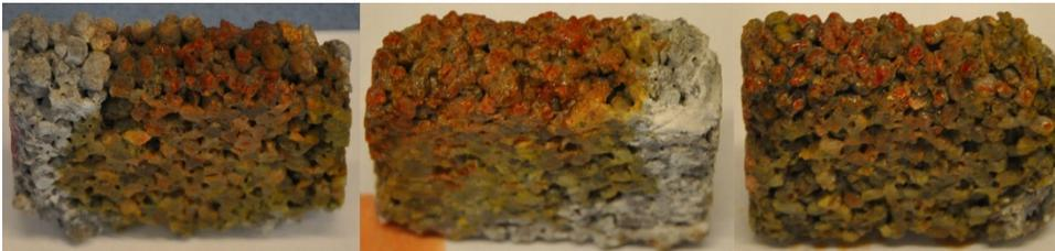
Abb. 5-26: Drainbeton mit Indikatorlösung: 2 Tage links, 4 Tage Mitte, 6 Tage rechts
