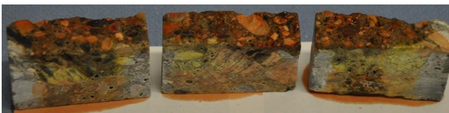
Abb. 5-29: Normalbeton mit Indikatorlösung mit Indikatorlösung nach 14 Tagen Wasserlagerung
