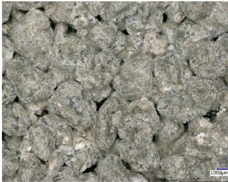
Abb. 4-18: Tiefenscharfes Bild – Drainbeton
