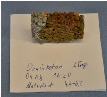
Abb. 4-16: 1. Diffusionsprüfung: Indikatorlösung auf Drainbeton nach 2 Tagen
