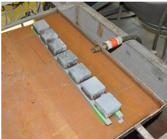
Abb. 4-5: Wasserlagerung kapillare Wasseraufnahme poröser UHPC
