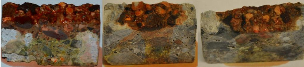
Abb. 5-25: Normalbeton mit Indikatorlösung: 2 Tage links, 4 Tage Mitte, 6 Tage rechts
