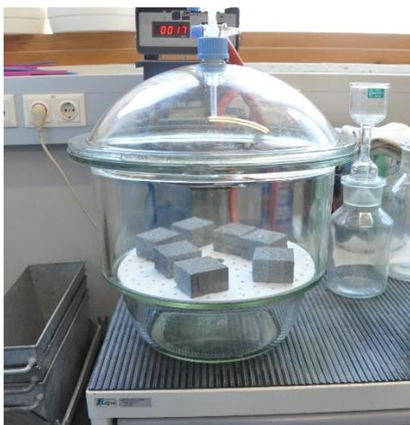
Abb. 4-6: Exsikkator mit porösen UHPC-Proben
