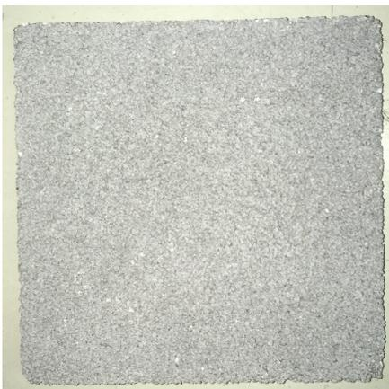
Abb. 3-5: Drainbeton
