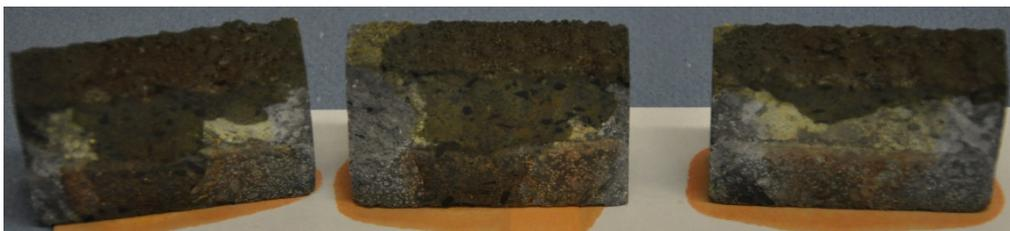
Abb. 5-28: Poröser UHPC mit Indikatorlösung nach 14 Tagen Wasserlagerung
