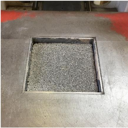
Abb. 3-8: In Betonplattenpresse eingelegte Drainbetonplatte
