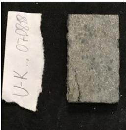
Abb. 4-13: Geschnittene poröse UHPC-Probe
