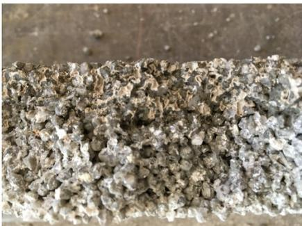
Abb. 3-10: Substratbeton gebrochen
