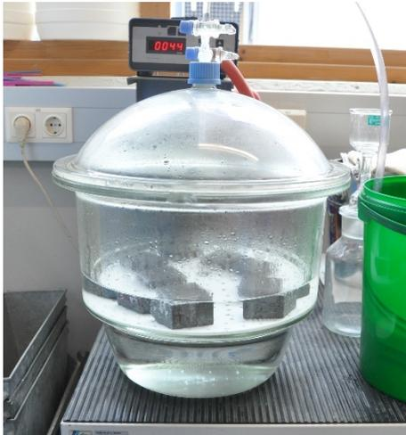
Abb. 4-7: Exsikkator mit porösen UHPC-Proben und entmineralisiertem Wasser
