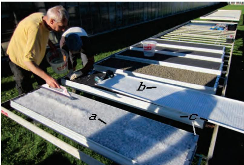
Abb. 2-1: Bestandteile der Paneele: a...Granulat, b...Fließ, c...Metall-Grundgerüst (Pont u. a., 2018)
