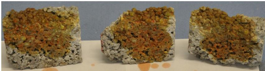
Abb. 5-31: Substratbeton mit Indikatorlösung nach 14 Tagen Wasserlagerung
