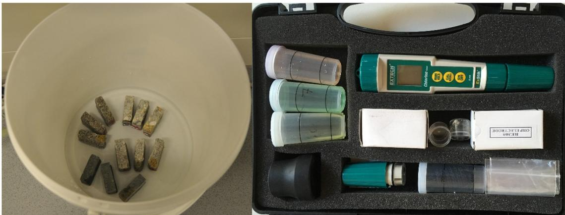
Abb. 4-17: Lagerung 2. Diffusionsprüfung (links), Chloridsonde mit pH Elektrodenmodul (rechts)
