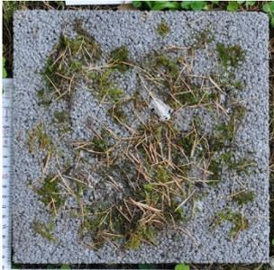
Abb. 3-18: Drainbeton nach 49 Tagen
