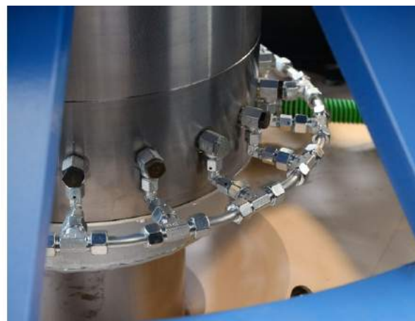
Abbildung 46: Hydrostatische Lagerung - links: Kraftaufnehmer mit Hebel; rechts: Druckölleitung
