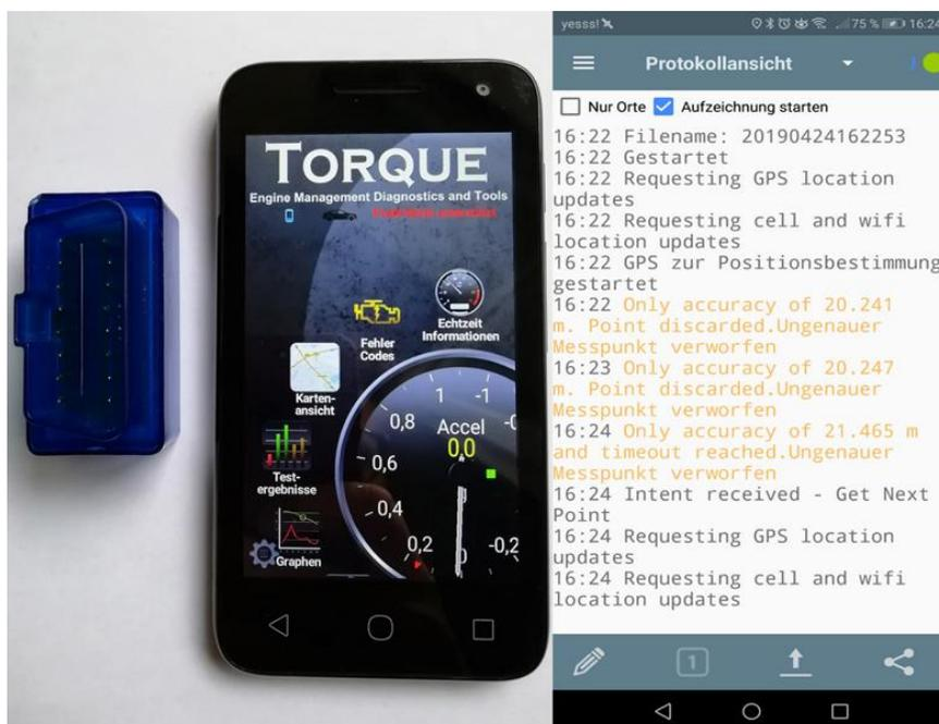
Abbildung 4.13: Darstellung OBD-Dongle mit Smartphone und App
