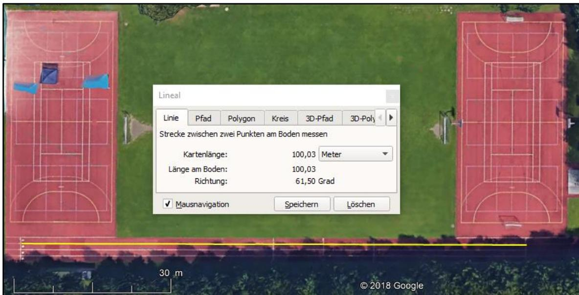
Abbildung 5.12: Distanzmessung mittels Google Earth Pro
