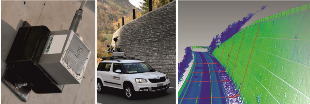
Abb. 97: Links: Neigungssensor zur Erfassung der Bauwerksveränderungen; Mitte: Dynamisches Mobile Mapping bei Stützbauwerken; Rechts: Querschnittsprofil generiert aus einer Punktwolke (Kalenjuk u. a., 2018)
