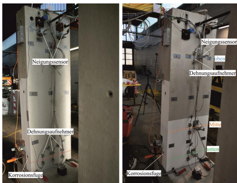
Abb. 112: Anordnung der Sensoren; Links: Entlang der Korrosionsfuge (SIBS_V2_03); Rechts: Vertikale Anordnung (SIBS_V2_02)
