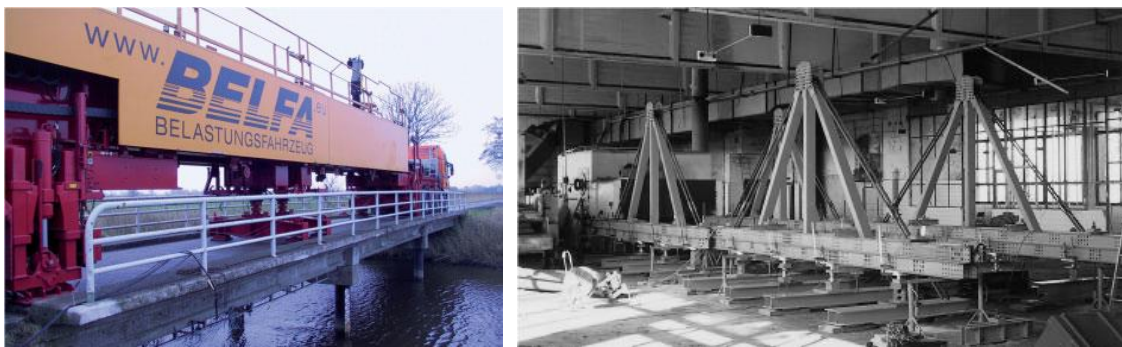
Abb. 24: Links: Belastungsfahrzeug BELFA für Brücken (Gutermann/Schröder, 2011); Rechts: Belastungsversuch an der Geschosdecke eines Hochbaues (Manleitner/Opitz/Steffens, 2001)
