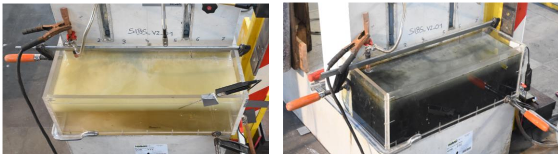
Abb. 105: Ablauf des Korrosionsprozesses am Versuchsstand SIBS_V2; Links: Beginn des Korrosionsprozesses; Rechts: Korrosionswanne nach ca. 30 min Korrosionsprozess
