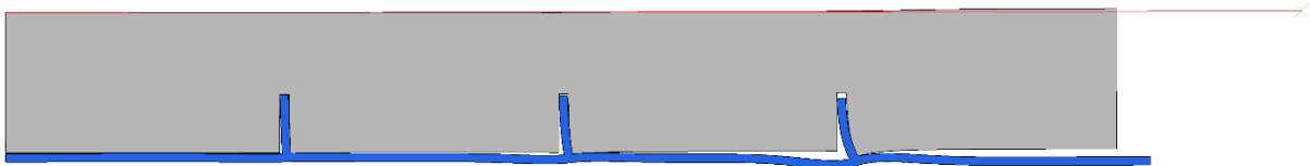
Abbildung 140 Geometrie 2, \mu=0,25 , Verformungsplot 100-fach überhöht, Deckeldruck 8,29 \text{ N/mm}^2
