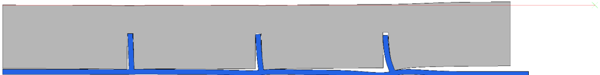
Abbildung 153 Geometrie 3, \mu=0,25 , Verformungsplot 100-fach überhöht, Deckeldruck 11,72 \text{ N/mm}^2
