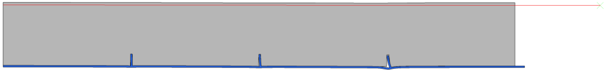
Abbildung 164 Geometrie 1, \mu=0 : Verformungsplot 100-fach überhöht, Deckel- und Innendruck
