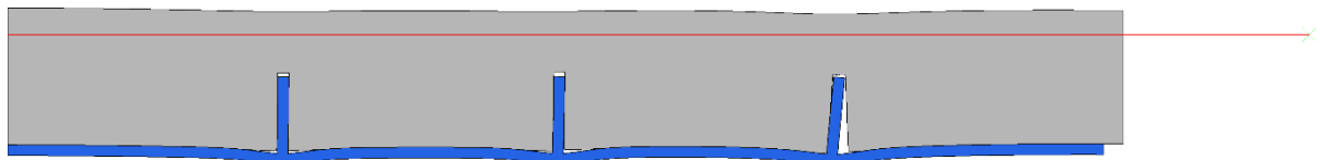
Abbildung 302 Geometrie 3, \mu=0,25 : Verformungsplot 100-fach überhöht: Innendruck
