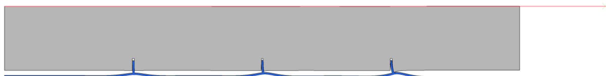
Abbildung 353 Geometrie 1, \mu=0,25 : Verformungsplot 100-fach überhöht, Außendruck und Temperatur
