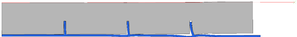
Abbildung 101 Geometrie 2, \mu=0 , Verformungsplot 100-fach überhöht, Deckeldruck 8,29 N/mm 2
