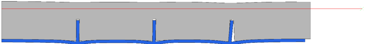
Abbildung 152 Geometrie 3, \mu=0,25 , Verformungsplot 100-fach überhöht, Innendruck 11,72 \text{ N/mm}^2
