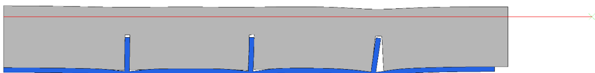
Abbildung 304 Geometrie 3, \mu=0,25 : Verformungsplot 100-fach überhöht: Innendruck und Temperatur
