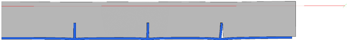
Abbildung 100 Geometrie 2, \mu=0 , Verformungsplot 100-fach überhöht, Innendruck 8,29 N/mm 2
