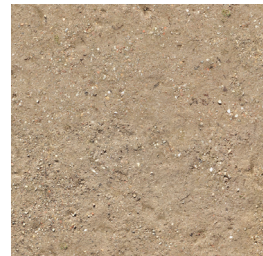
[Abb. 123] Wassergebundene Wegedecke Rad- und Promenadenwege
