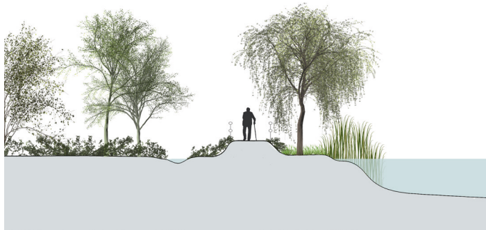
[Abb.107] Trennung von Bach und Baggersee
