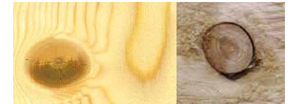
Abb. 34: fest verwachsener und nicht verwachsener Ast
