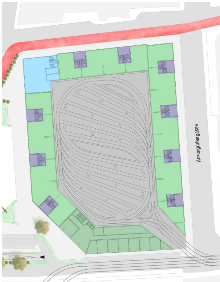
Abbildung 64: Gleisplan der neuen Remisenfläche
