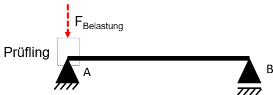
Abbildung 3.7: Schem. Darstellung Kraftverteilung tragendes Konzept
