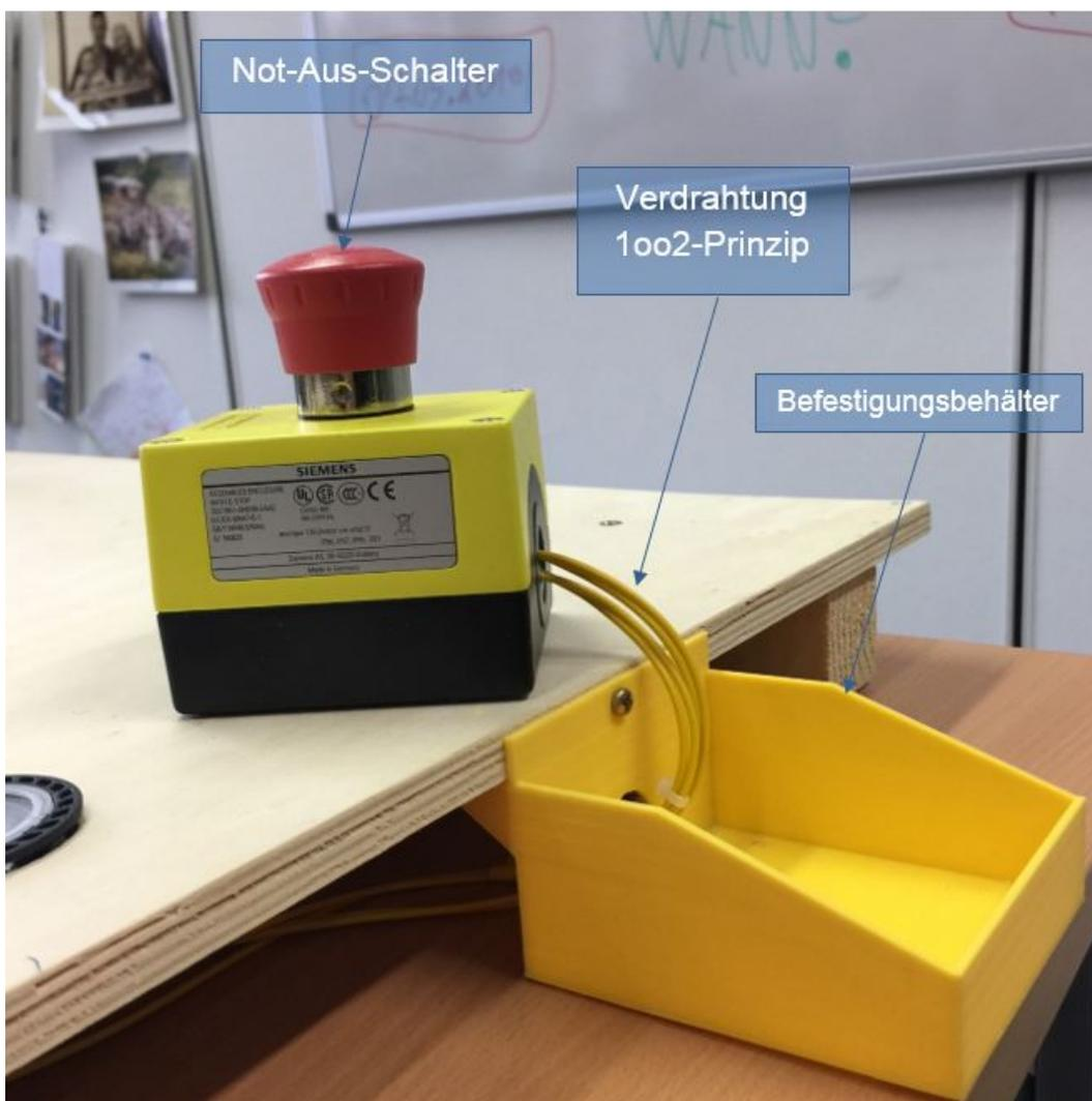
Abbildung 6.2: Not-Aus-Taster und Montage
