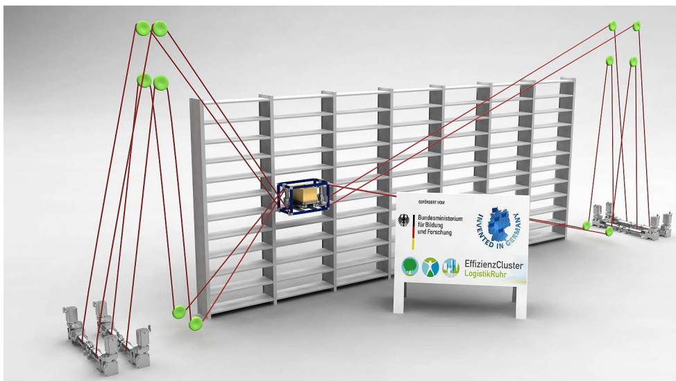
Abbildung 1.2: Regalbediengerät auf Basis der STEWART-GOUGH-Plattform
