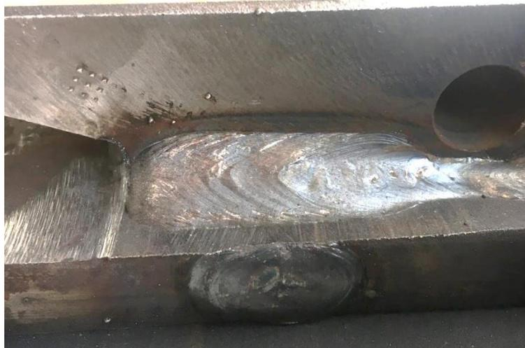
Abbildung 95: Spezialfall: Kreuzung der UP Naht mit MAG Kehlnaht
