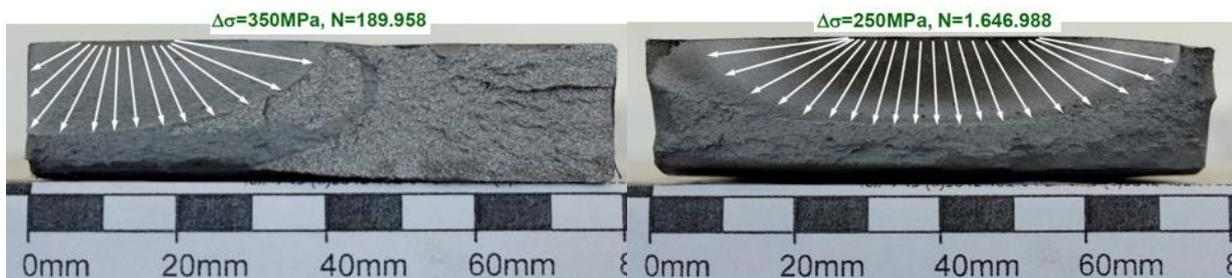
Abbildung 52: Bruchfläche der UP Probe bei  $\Delta\sigma=350$  MPa (links) und  $\Delta\sigma=250$  MPa (rechts)
