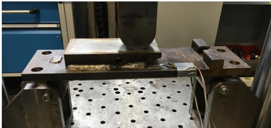
Abbildung 65: Versuchsaufbau DMS Messung RPG
