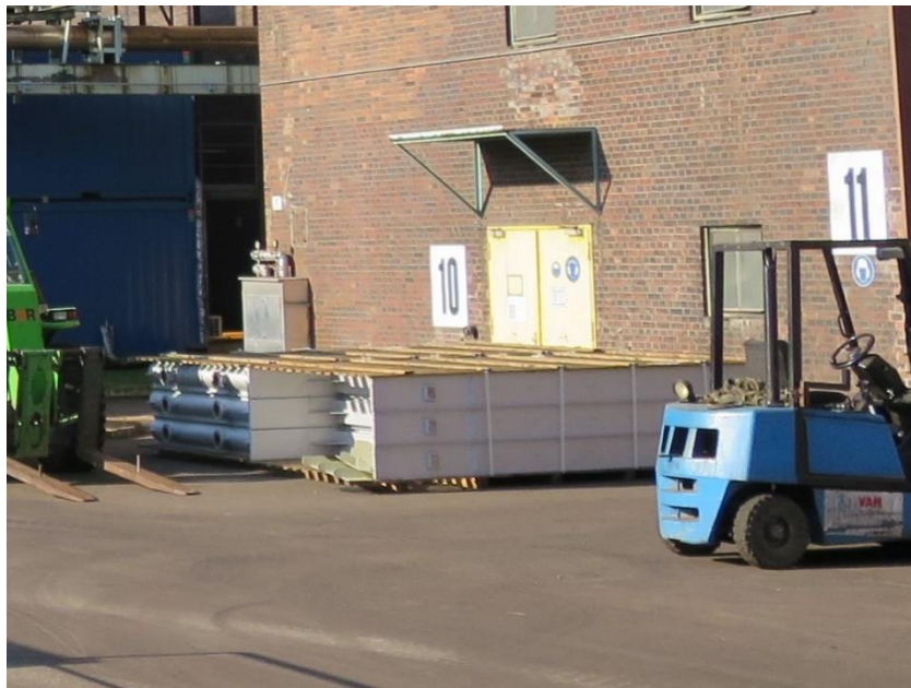
Abbildung 150 - Neue Register für die Kondensatunterkühlstufe
